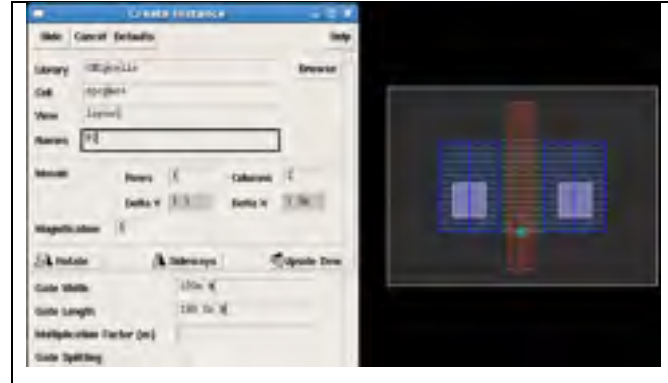
Figure 6.8 Cellule paramétrique PMOS
