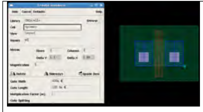
Figure 6.7 Cellule paramétrique NMOS
