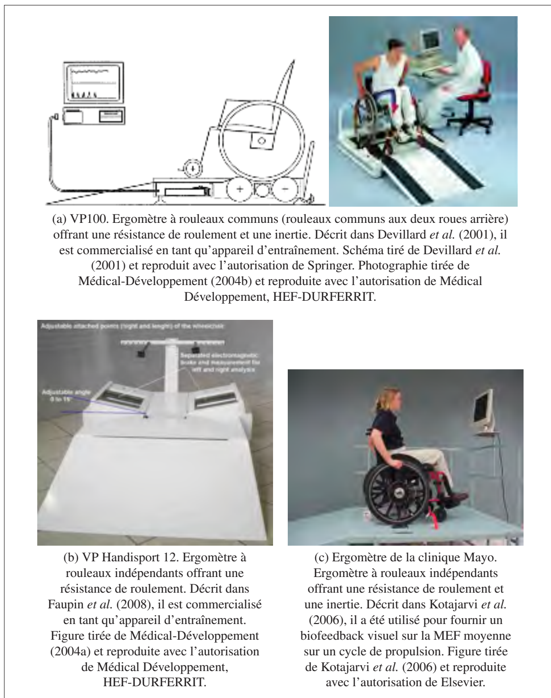
Figure 1.10 Schémas et photographies d'ergomètres à rouleaux
