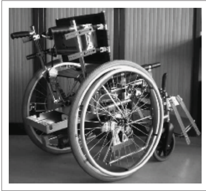
Figure 1.9 Photographie d'un ergomètre mobile. Figure tirée de Sauret et al. (2011) et reproduite avec l'autorisation de Taylor & Francis Group
