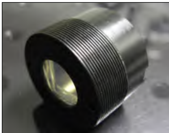
Figure 2.1 Filtre supprimeur fixe
