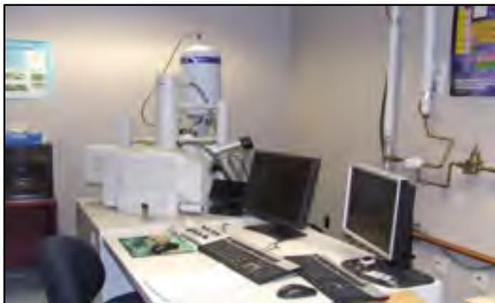
Figure 2.14 Microscopie électronique à balayage et microanalyse (Hitachi S-3600N)
