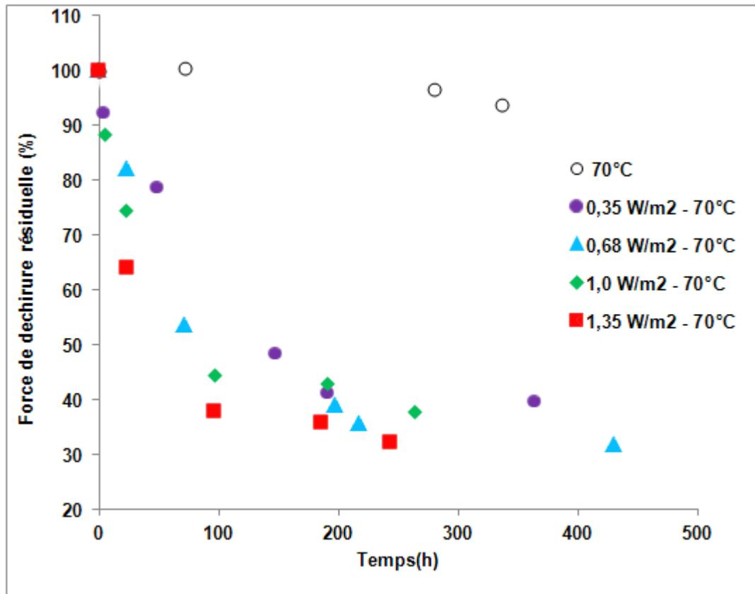
Figure 4.4 Évolution de la force de déchirure de la membrane en fonction de l'intensité lumineuse et de la durée du photovieillissement (T= 70°C)
