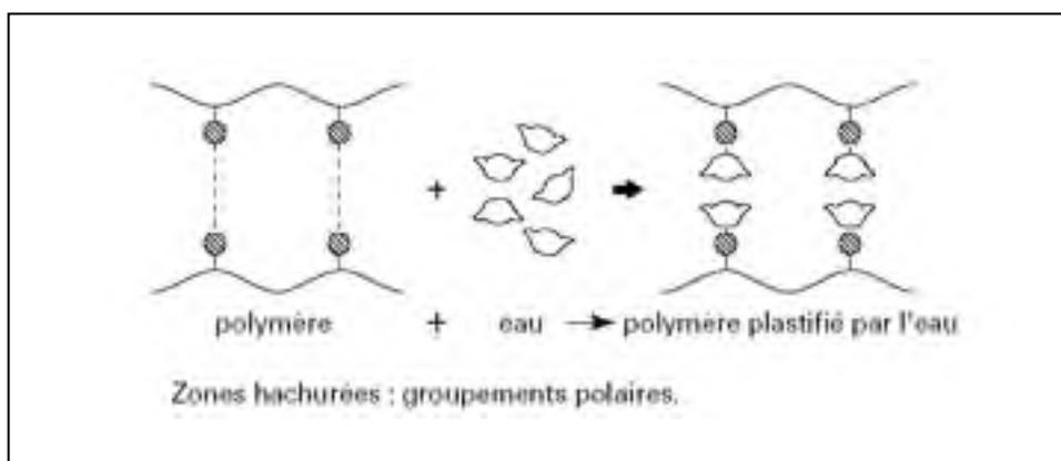
Figure 1.4 Effet plastifiant des molécules d'eau sur un polymère
