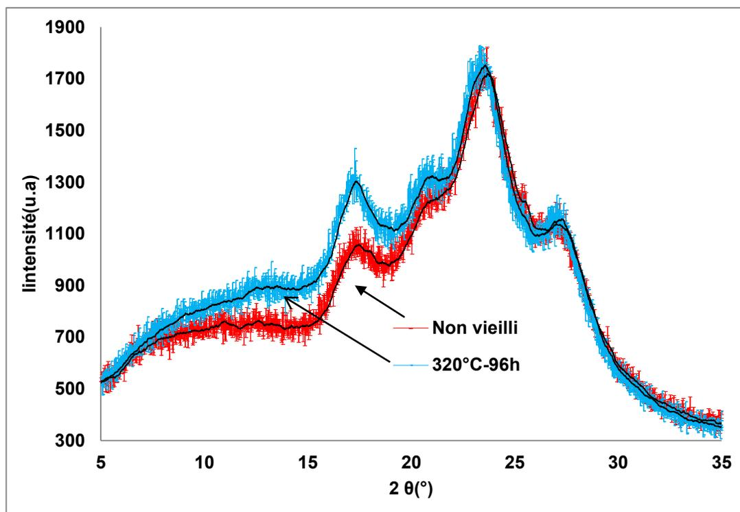
Figure 3.20 Spectres DRX du Nomex<sup>®</sup> non vieilli et vieilli à 320°C pendant 4 jours
