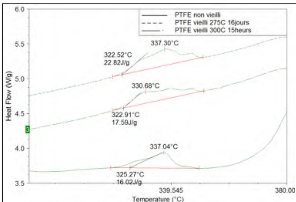
Figure 3.19 Évolution de la température du pic de fusion de e-PTFE non vieilli et vieillis à 275°C et 320°C
