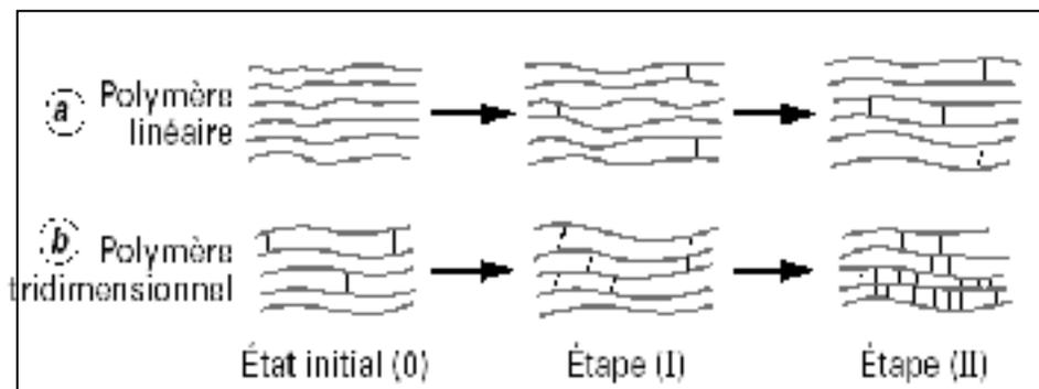
Figure 1.2 Représentation schématique des processus de réticulation dans un polymère initialement linéaire et dans un polymère initialement tridimensionnel
