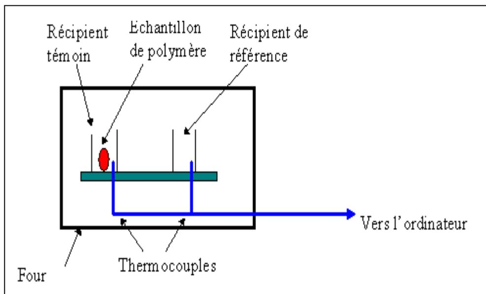
Figure 2.15 Principe de fonctionnement de DSC
