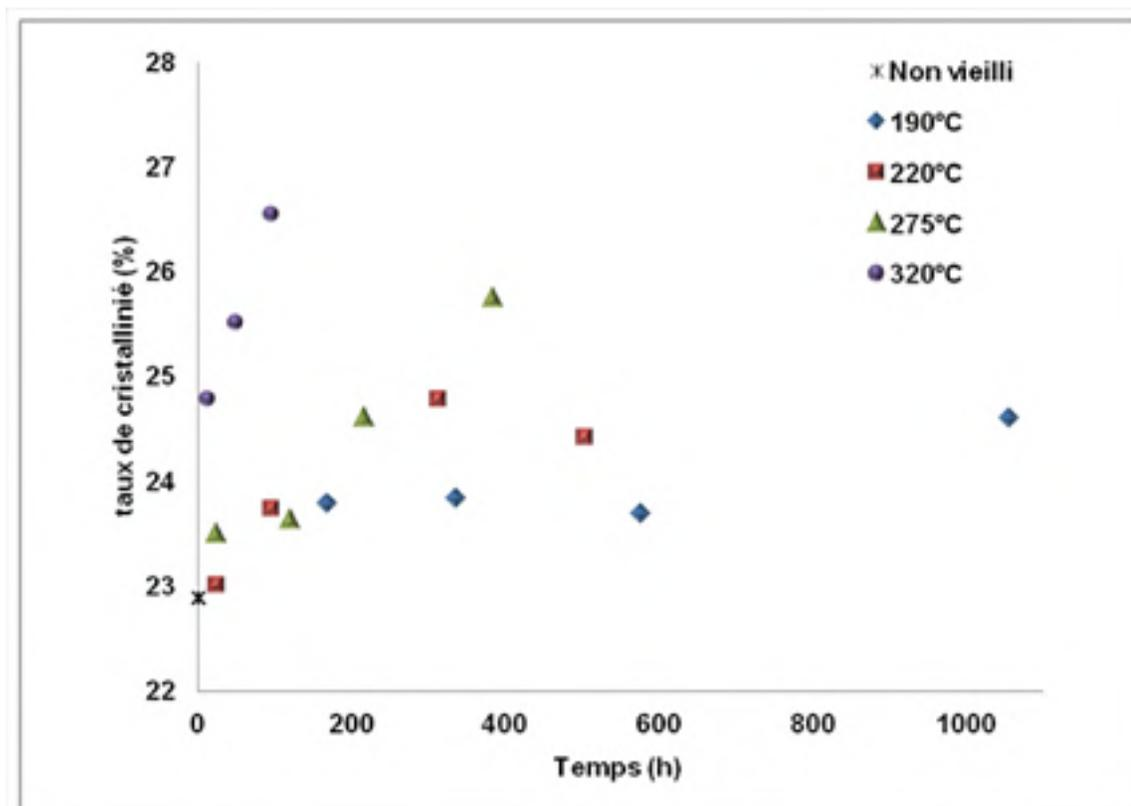
Figure 3.21 Évolution de la cristallinité du Nomex<sup>®</sup> par DRX en fonction de la température et de la durée du vieillissement thermique
