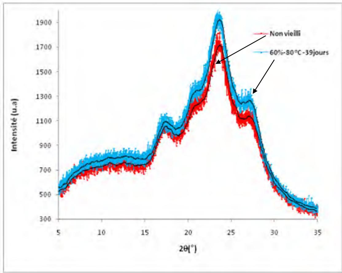
Figure 5.5 Spectres DRX du Nomex® non vieilli et vieilli à 60%-80°C pendant 39 jours
