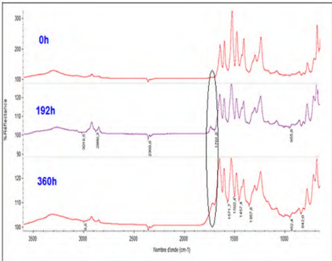
Figure 4.11 Évolution des spectres IR-ATR de la fibre de Nomex® au cours de l'irradiation photochimique (70°C, 0,68 W/m<sup>2</sup>)
