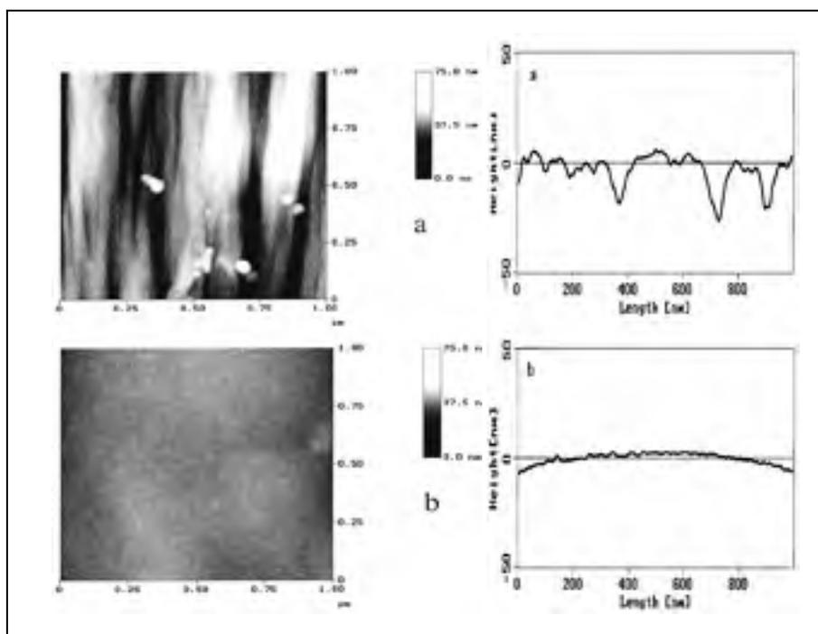
Figure 1. 22 Images AFM de la fibre Nomex<sup>®</sup> avant et après pyrolyse
