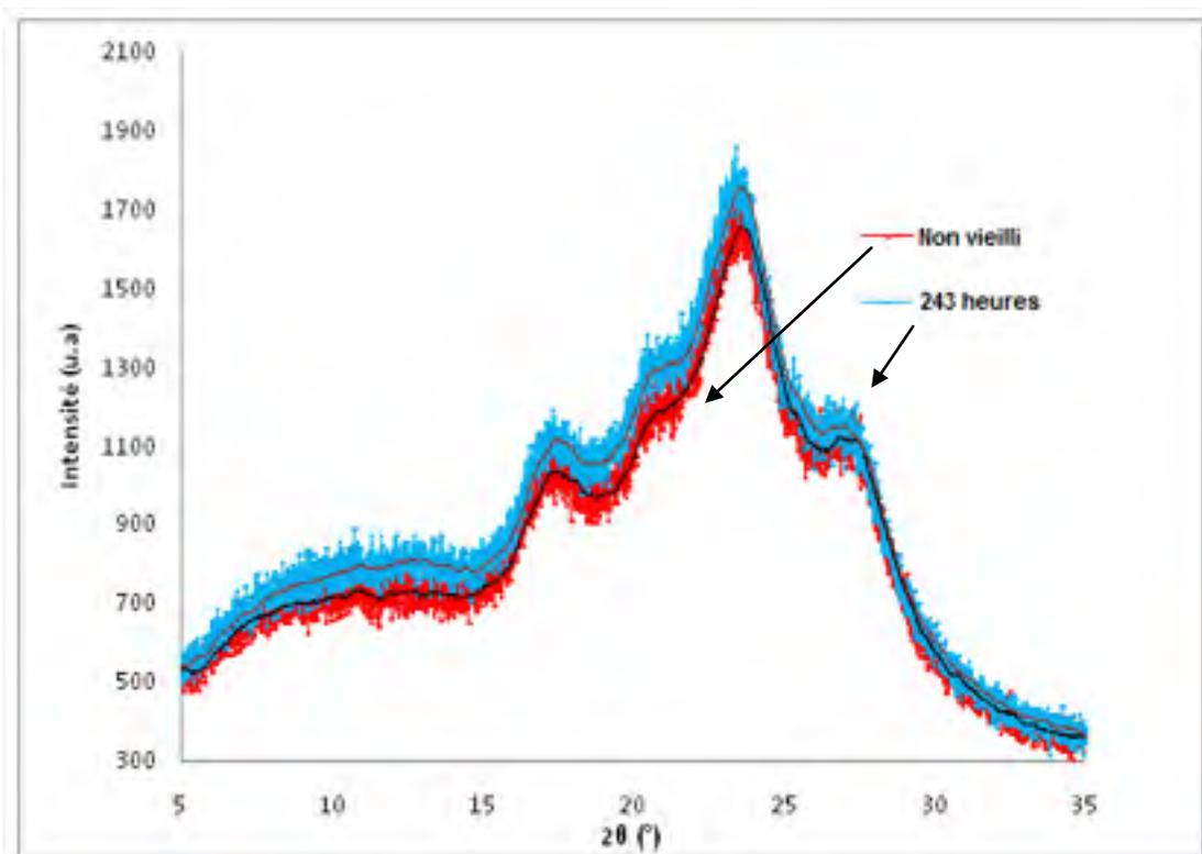
Figure 4.14 Spectres DRX du Nomex® non vieilli et vieilli à 1,35 W/m<sup>2</sup> à 70°C
