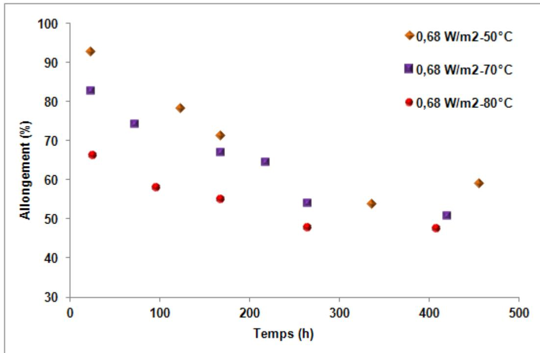
Figure 4.10 Évolution de l'allongement à la rupture de la membrane e-PTFE/Nomex<sup>®</sup> en fonction de l'intensité lumineuse et de la durée du photovieillissement (T= 50,70 et 80°C)
