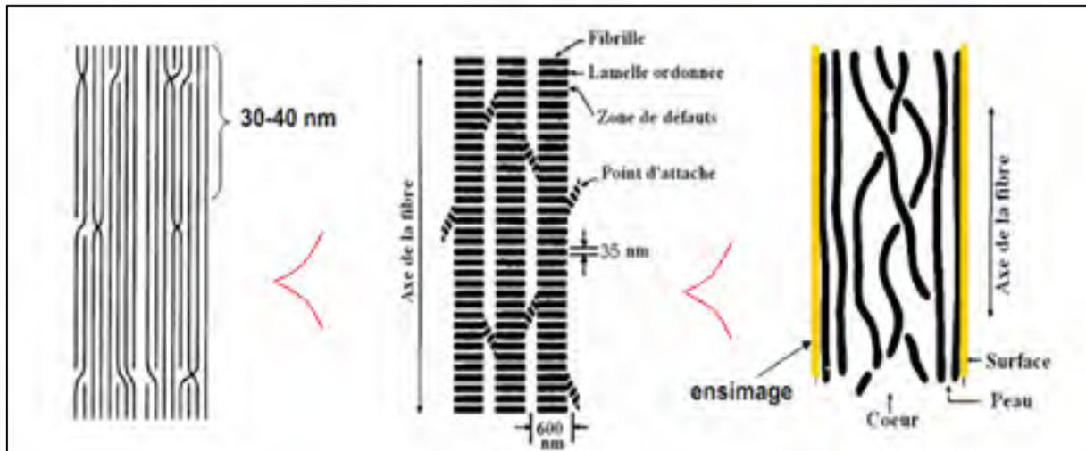
Figure 1.17 Principaux modèles de structure des fibres
