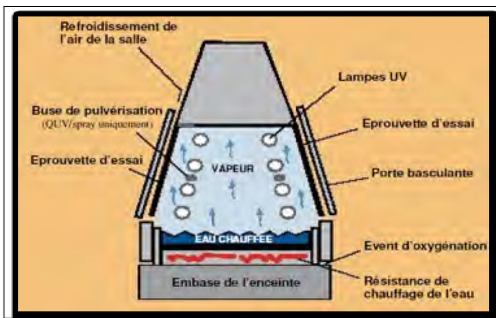
Figure 3.3 Coupe du QUV lors de la phase de condensation
