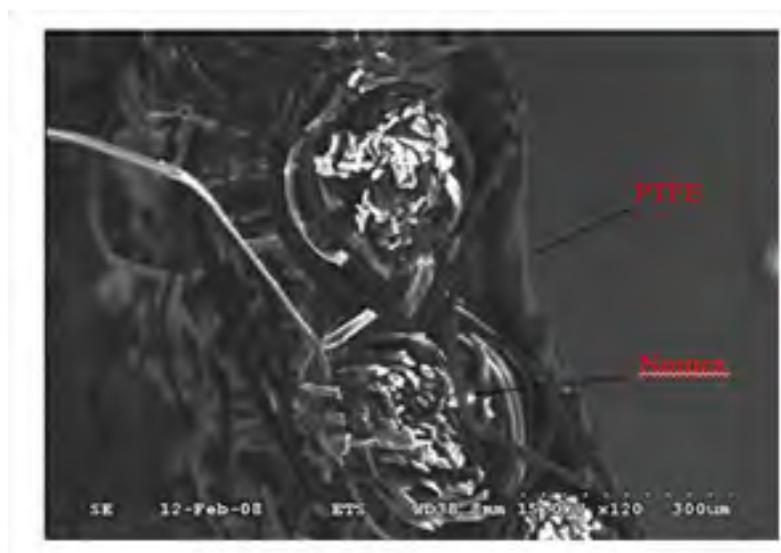
Figure 3.5 Image MEB de la membrane e-PTFE/Nomex<sup>®</sup>
