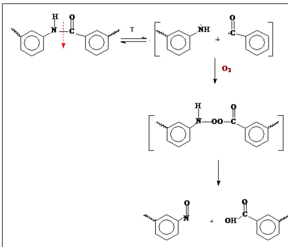
Figure 3.16 Mécanisme de dégradation thermique du Nomex<sup>®</sup>
