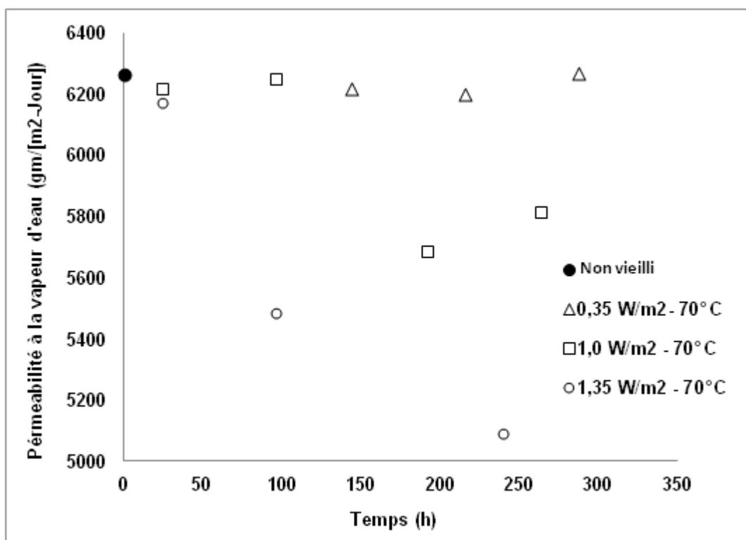
Figure 4.1 Évolution de la perméabilité à la vapeur d'eau de la membrane e-PTFE/Nomex<sup>®</sup> en fonction de l'intensité lumineuse et de la durée du vieillissement
