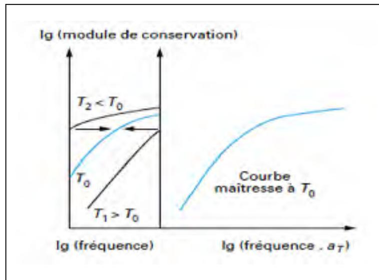
Figure 1.9 Schématisation du principe de superposition temps-température (STT)
