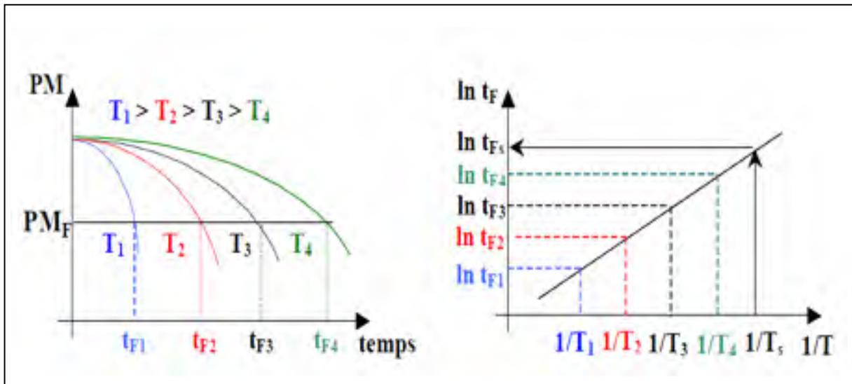
Figure 1.8 Principe de l'extrapolation arrhenienne
