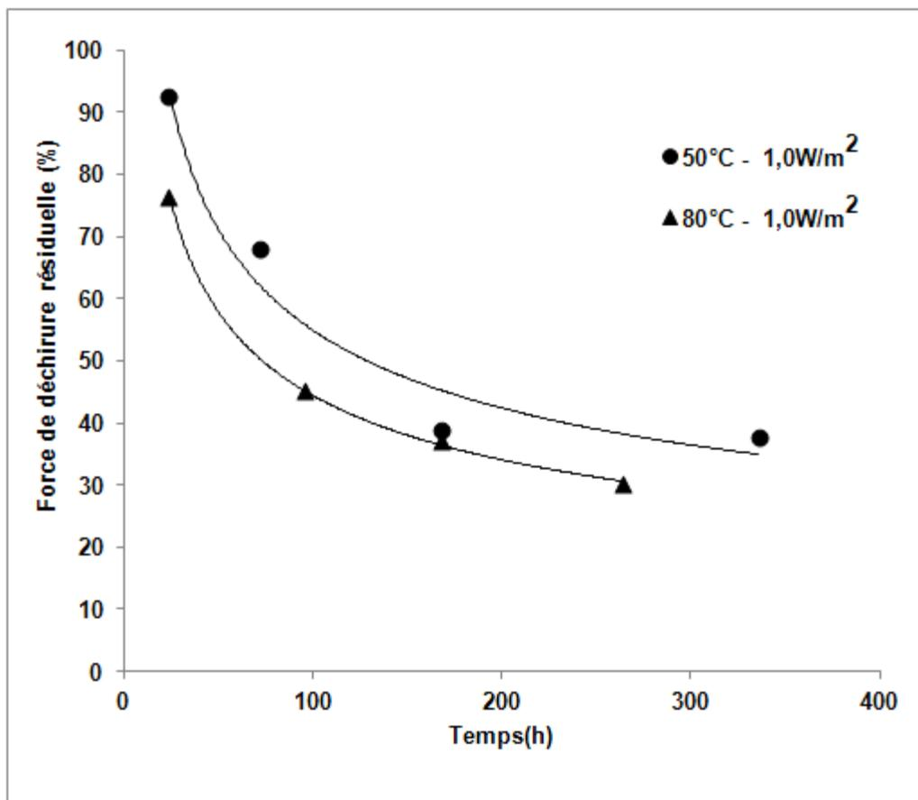
Figure 4.7 Effet de la température sur la vitesse de photodégradation de la membrane e-PTFE/Nomex<sup>®</sup>
