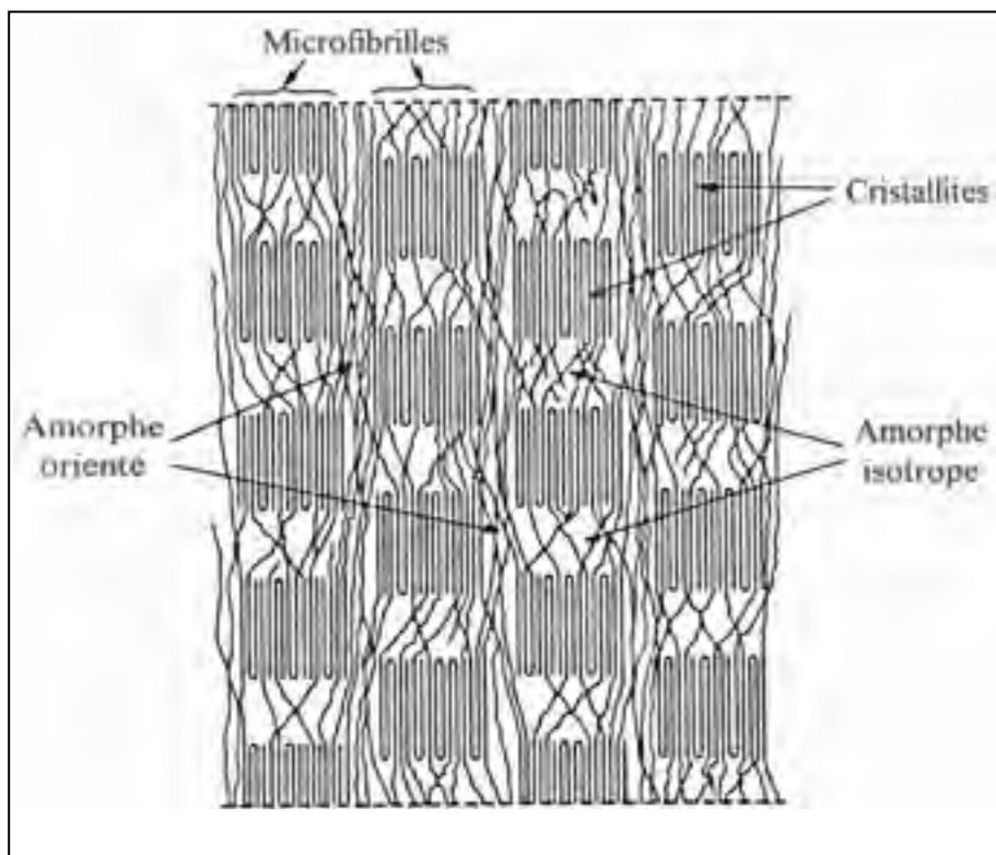
Figure 1.18 Zones amorphes et cristallines dans les fibres polymères
