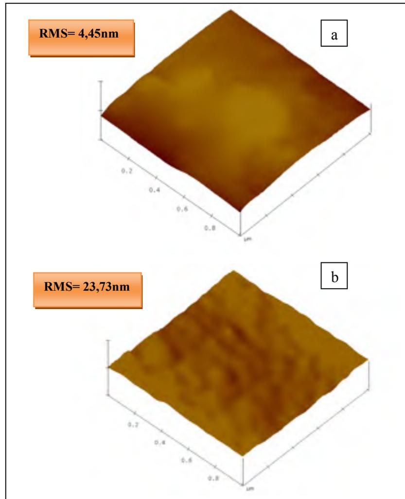
Figure 4.18 Image par AFM de la surface d'une fibre de Nomex<sup>®</sup> non- vieillie (a) et vieillie à 0,68 W/m<sup>2</sup> à 80°C pendant 168 heures (b)
