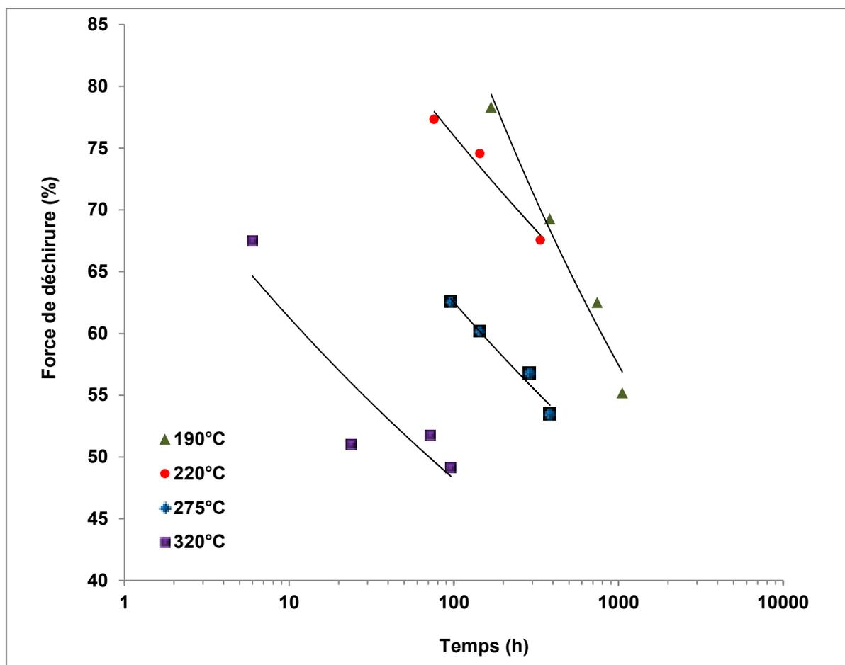
Figure 3.13 Évolution de la force de déchirure de tissu de Nomex<sup>®</sup> en fonction de la température et de la durée du vieillissement thermique
