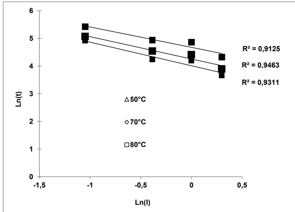
Figure 4.22 Variation du logarithme des temps de vie correspondant à l'effet du vieillissement photochimique sur la force de déchirure en fonction du logarithme de l'intensité lumineuse
