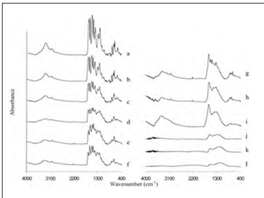
Figure 1. 21 Spectres FTIR de la fibre Nomex<sup>®</sup> neuve(a) et vieillie à différentes températures : 633K(b), 706K(c), 746K(d), 803K(e), 823K (f), 873K(g), 933K (h), 973K(i), 1023K(j), 1073K(k), et 1173K(l)
