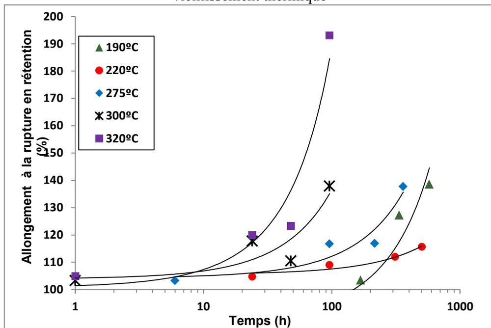
Figure 3.10 Évolution de l'allongement à la rupture en fonction de la température et de la durée du vieillissement thermique
