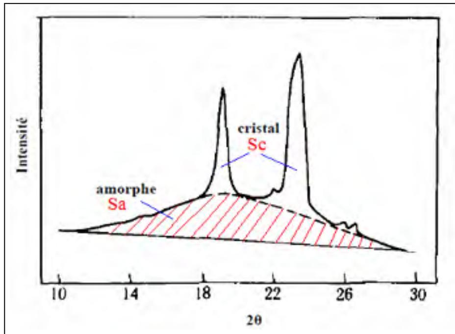
Figure 2.12 Diffraction des rayons X d'un polymère semi cristallin
