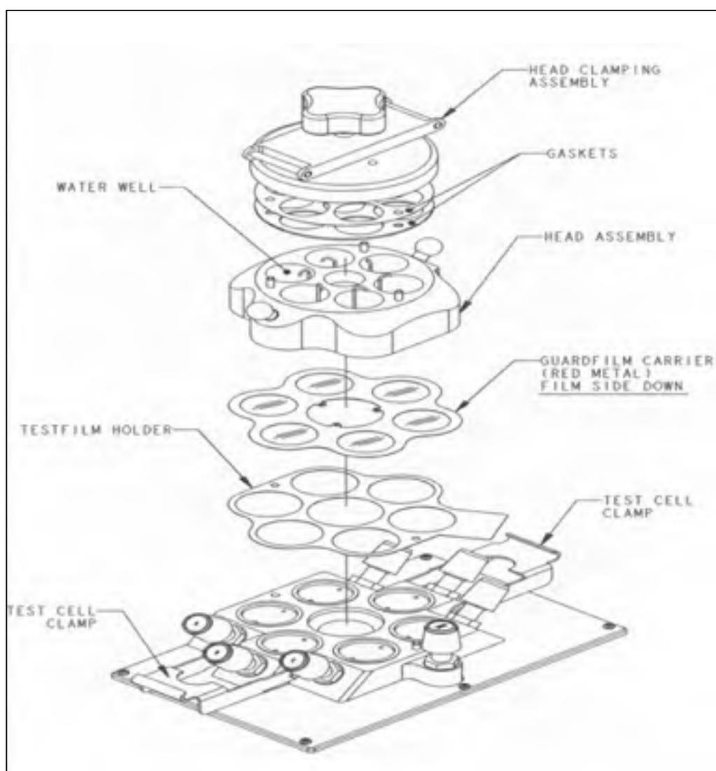
Figure 2. 8 Schéma de mesure de la perméabilité à la vapeur d'eau
