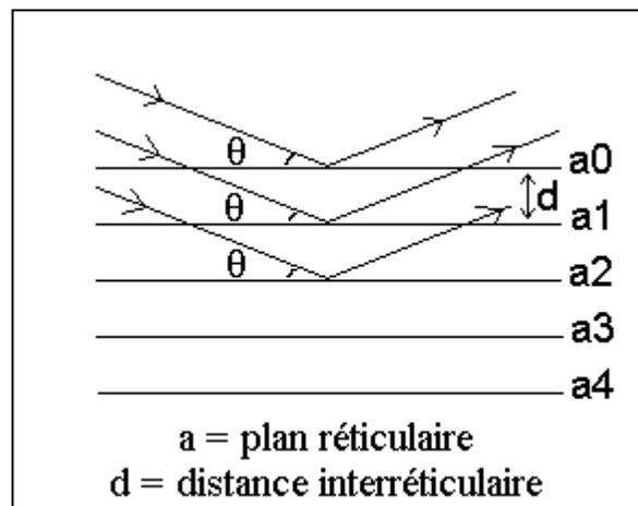
Figure 2. 10 Principe de la loi de Bragg
