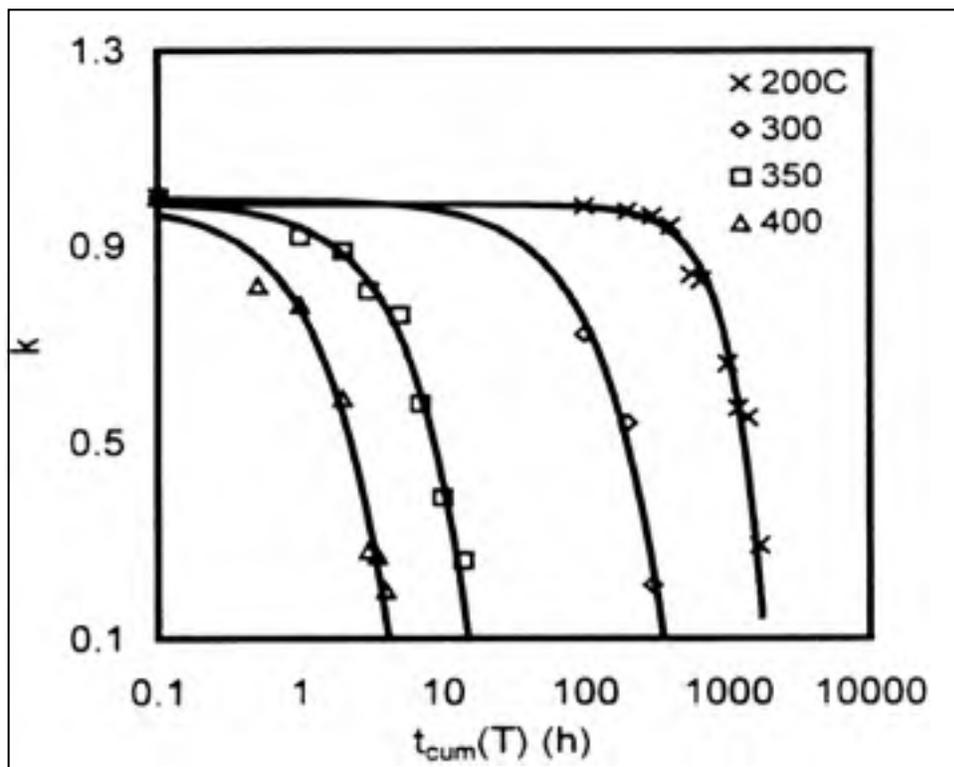
Figure 1. 23 Évolution de la cristallinité du Nomex<sup>®</sup> en fonction de la température et de la durée du vieillissement thermique
