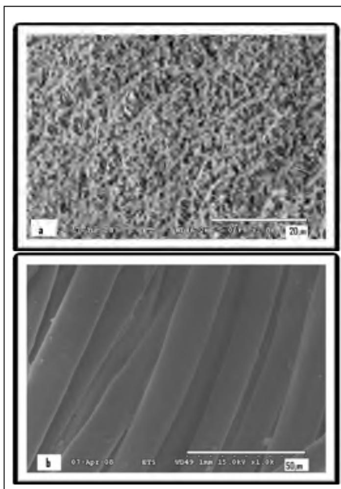
Figure 2. 1 Photos MEB de la membrane de l'humidité (a) côté e-PTFE et (b) côté Nomex<sup>®</sup>
