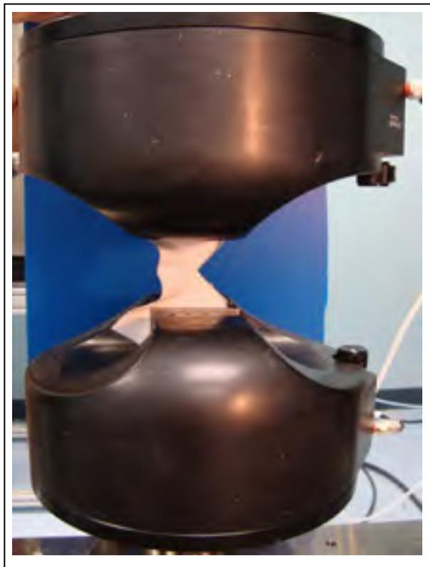
Figure 2.7 Principe du test de déchirure
