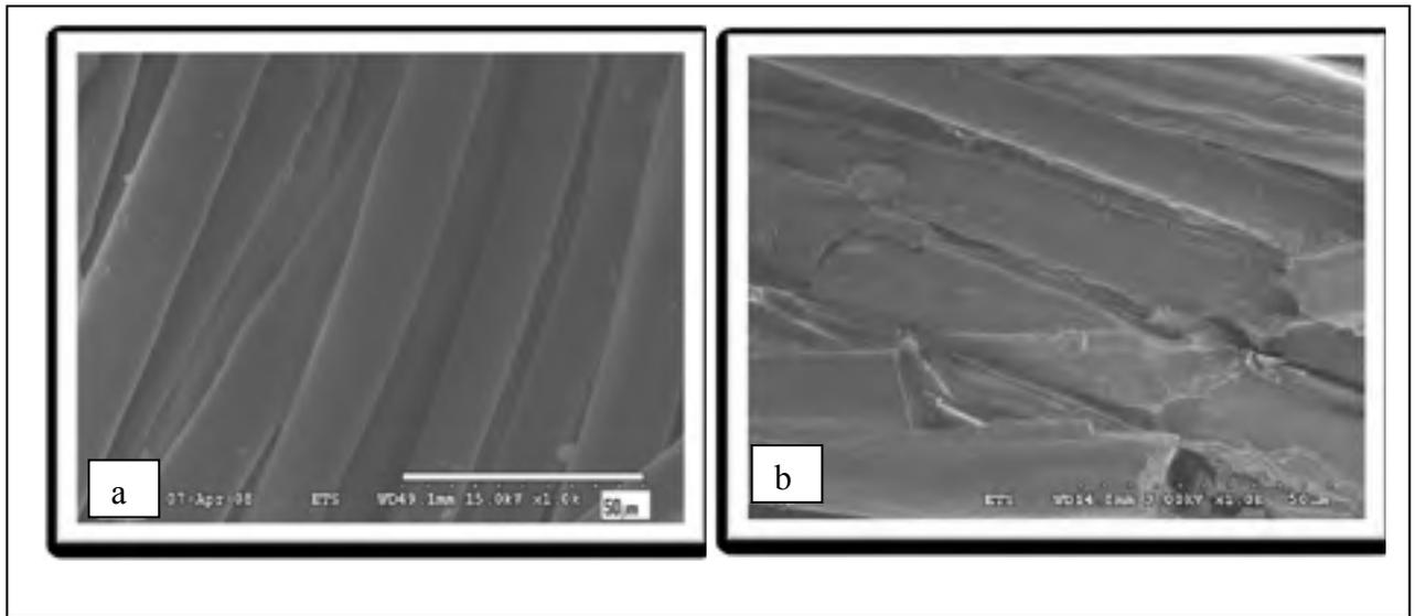
Figure 6.2 Images MEB des fibres du Nomex<sup>®</sup> non vieilli (a) et vieilli par des cycles alternés  $0,68 \text{ W/m}^2 + 100\% + 50^\circ\text{C}$  pendant 312 heures
