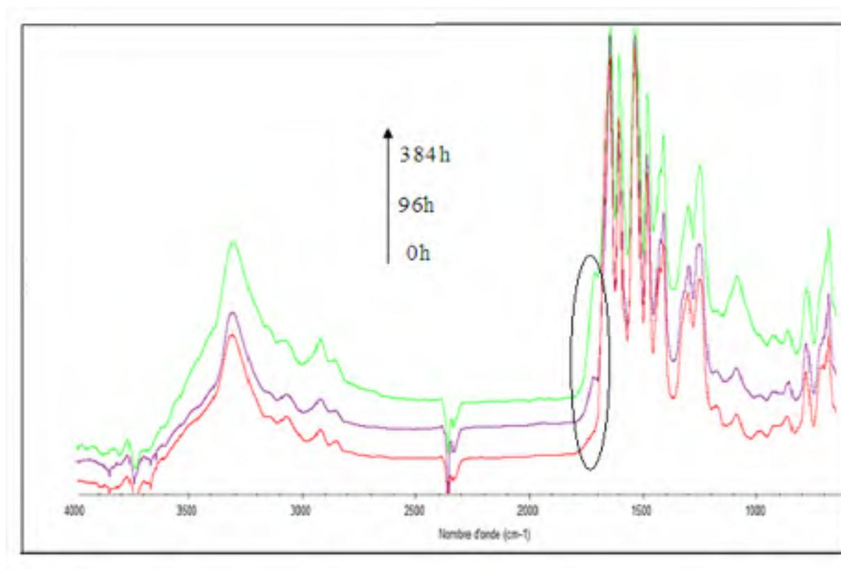
Figure 3.14 Evolution de la structure chimique du Nomex<sup>®</sup> non vieilli et vieilli à 275°C pendant 96 h et 384 h en fonction de la durée de vieillissement
