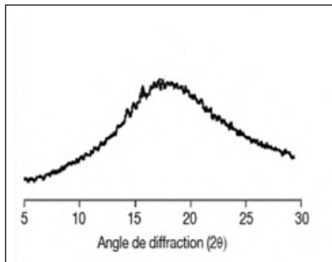
Figure 2.11 Diffraction des rayons X d'un polymère amorphe
