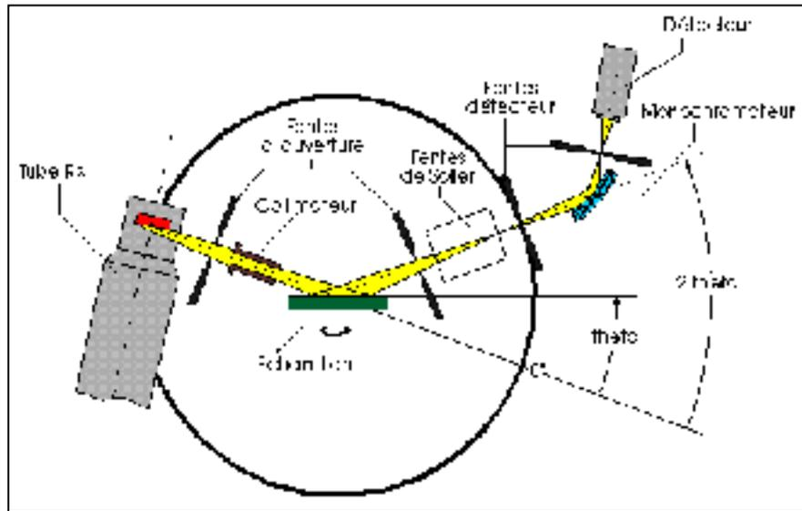
Figure 2. 9 Schéma du principe de diffraction des rayons X
