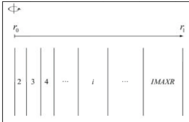
Figure 2.4 Représentation schématique de la géométrie d'un maillage local (tirée de Chapuis 2009 p.33)
