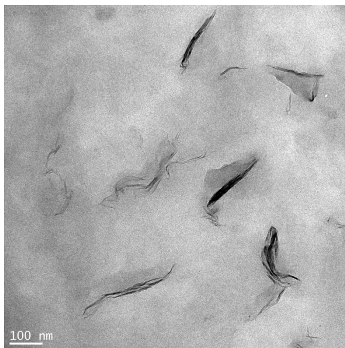
Figure 2.5 Image TEM à 100nm d'un échantillon LLDPE/nano-glaises 97/3 %
