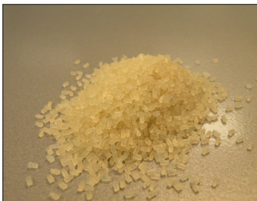
Figure 2.4 Pastilles de nanocomposites à la sortie de l'extrudeuse Tirée de Trudel (2011, p. 46)
