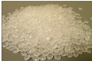
Figure 2.1 Granules de polyéthylène linéaire basse densité FPS 117-D de Nova Chemicals Tirée de Trudel (2011, p. 40)
