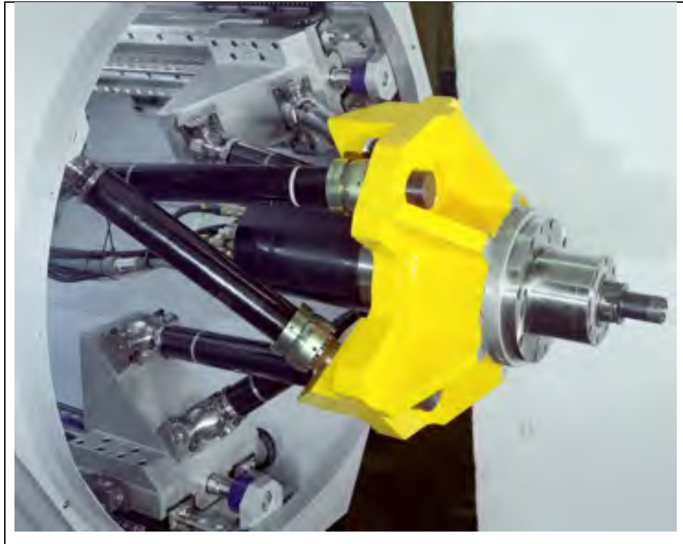
Figure 1.7 Robot parallèle à trois ddl (HERMES de FATRONIK) utilisé dans les machines-outils à cinq axes
