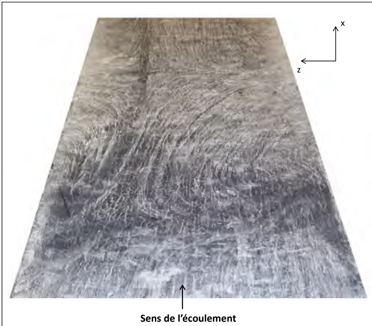
Figure-A V-1 Photographie de la visualisation par film d'huile de l'écoulement pariétal sur la surface d'essai de notre berceau (surface supérieure) pour U_{\text{réf}} = 30 \text{ m.s}^{-1} . Les dimensions réelles de la plaque sont 60x150cm.
