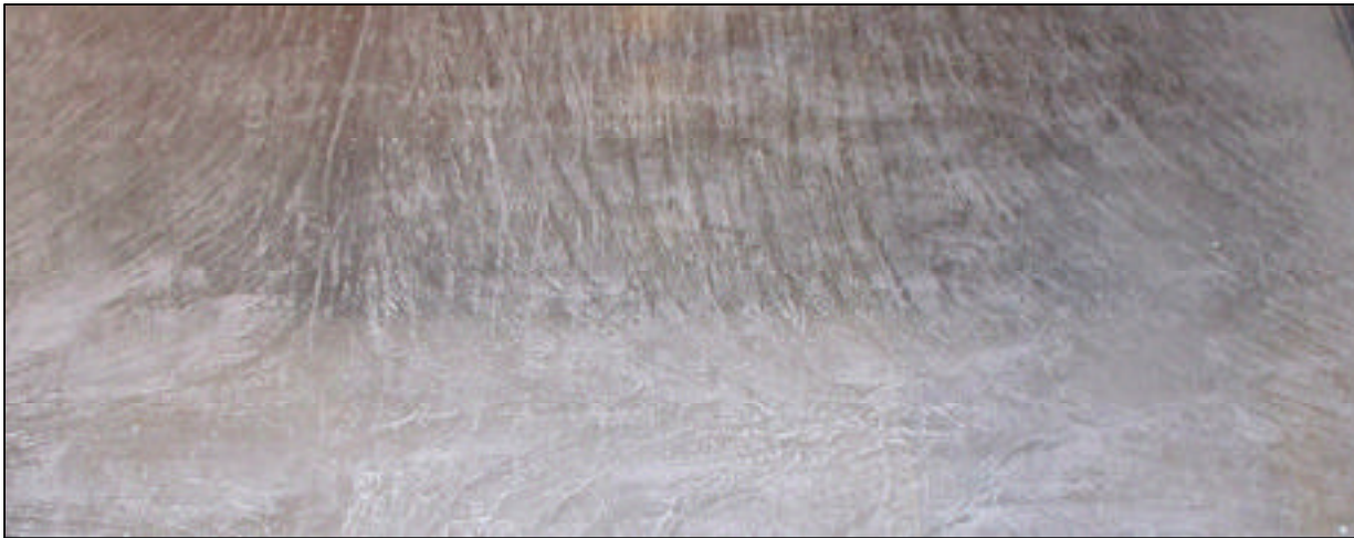
Figure 5.4 Exemple de visualisation obtenue par la méthode du film d'huile U_{\text{réf}}=30\text{m}\cdot\text{s}^{-1}
