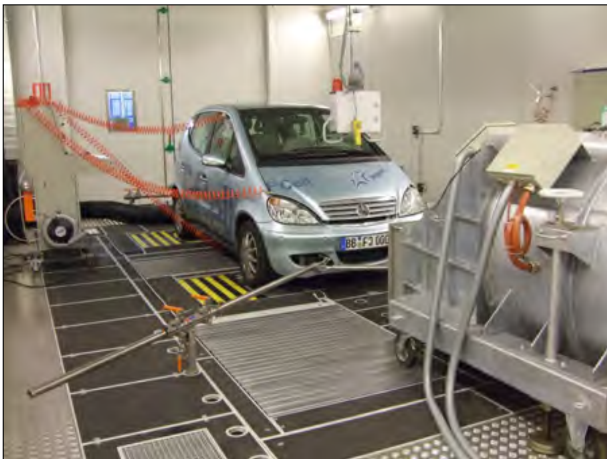
Figure 1.2 Véhicule sur un dynamomètre à rouleau Tirée de Joint Research Center, European Commission < http://ec.europa.eu >
