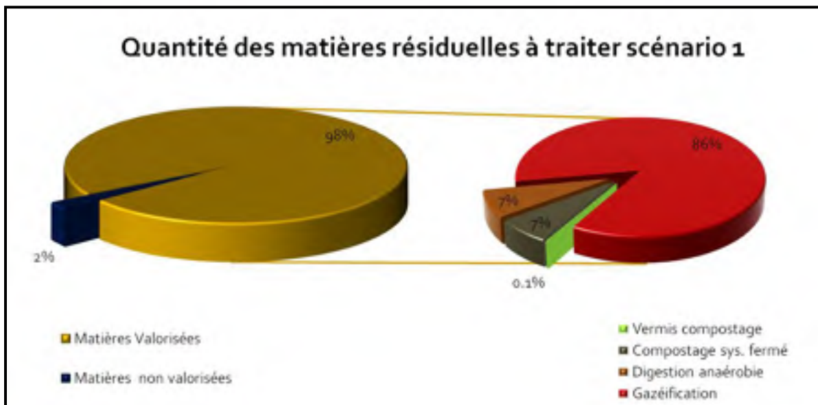
Figure 3.7 Quantité de matières traitées dans le scénario 1
