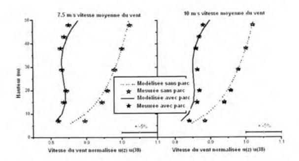
Figure 9 Profils verticaux des vitesses normalisées, mesurées et modélisées du vent, sans le parc et avec le parc. Un quintuple sillage du parc de Vindeby est considéré avec des conditions de stabilité quasi-neutres et une intensité de turbulence de 6% (tirée de [12]).
