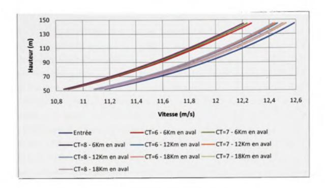
Figure 45 Variation de  $C_{\tau}$  - Profils des vitesses
