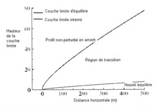
Figure 13 Différentes régions de la couche limite en présence d'une rugosité (tirée de [17])
