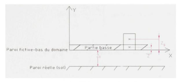
Figure 21 Disposition des cellules près du sol
