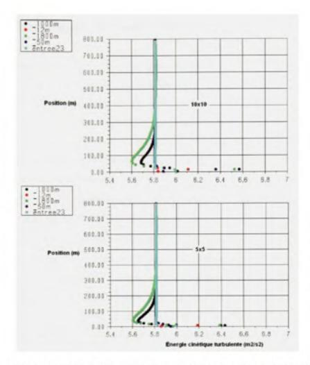
Figure 27 Variation des profils de l'énergie cinétique dans deux cas de maillage
