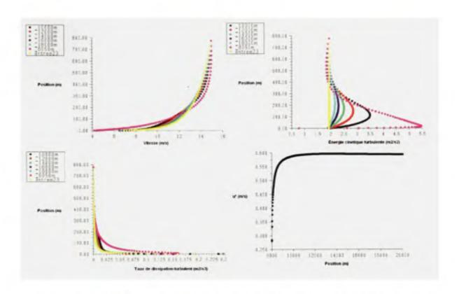
Figure 32 Profils de vitesse, k et E et de vitesse de friction dans la région aval
