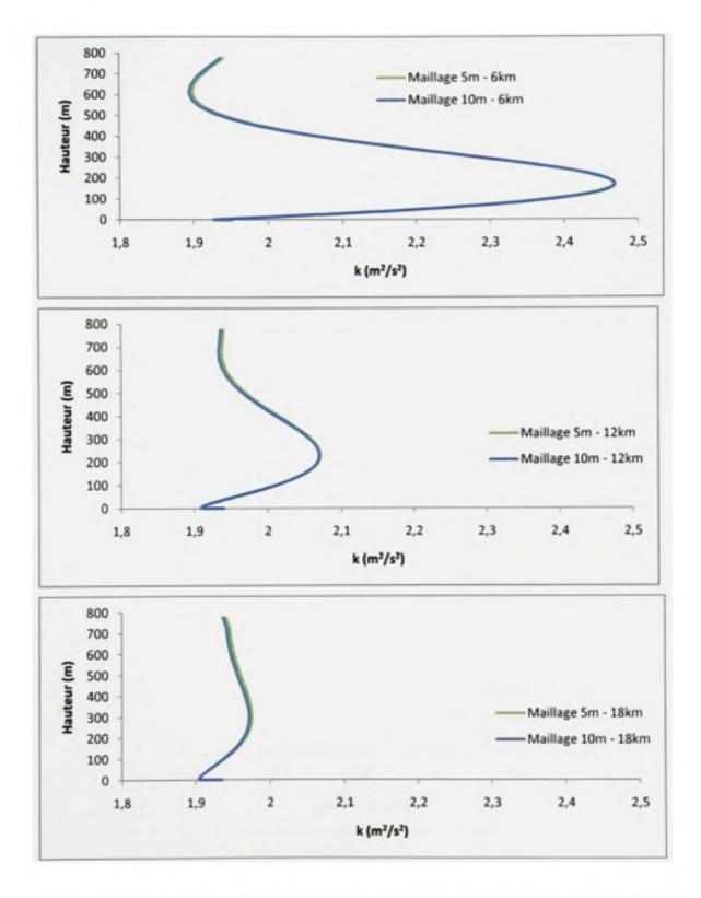
Figure 42 Maillages 5m et 10m de largeur de cellule - Profils de l'énergie cinétique à 6km, 12km et 18km en aval du parc
