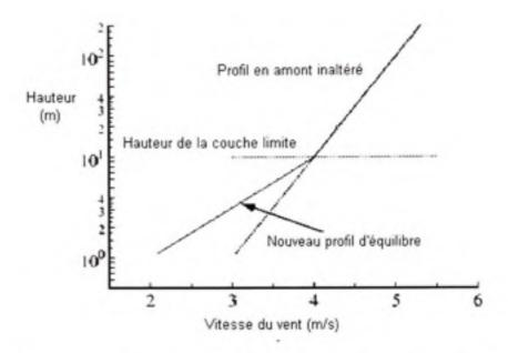
Figure 14 Effet de la rugosité sur le profil de la vitesse du vent (tirée de [17])
