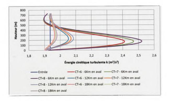
Figure 46 Variation de  $C_{\tau}$  - Profils de k
