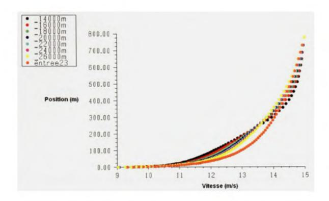
Figure 38 Profils de vitesse en aval du parc - Implantation en mer
