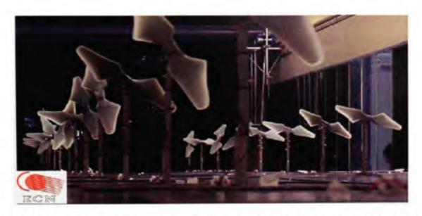
Figure 6 Parc éolien comprenant 14 rangées de 2 turbines dans la soufflerie (tirée de [8])
