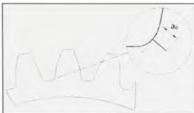
Figure 1.9 Orientation de la fissure initiale.
