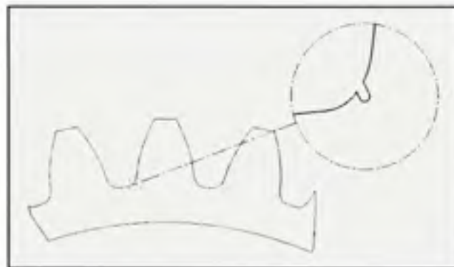
Figure 1.6 Exemple d'initiation artificielle d'une fissure en flexion.
