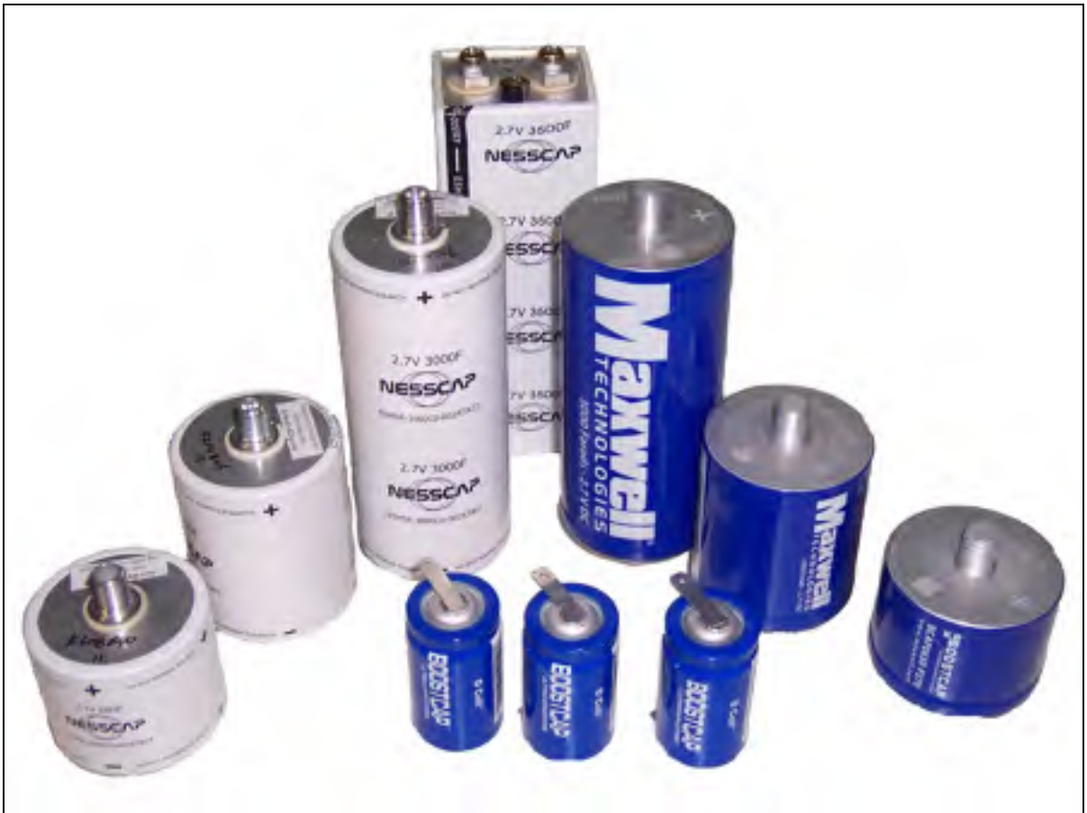
Figure 6.3 Supercondensateurs du laboratoire
