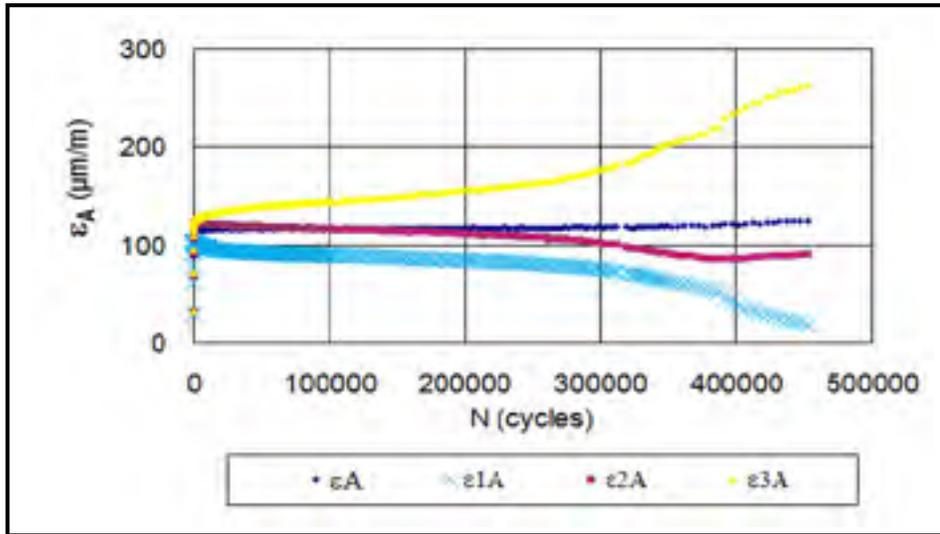
Figure 6.15 Évolution de l'amplitude des déformations en fonction du nombre de cycles pour l'essai P3-B2 en mode de déformation (GB20 PG58-28;  $T_{\text{consigne}} = 10\text{ }^{\circ}\text{C}$ ;  $Fr = 10\text{ Hz}$ ;  $\epsilon_0 = 120\text{ }\mu\text{def}$ )
