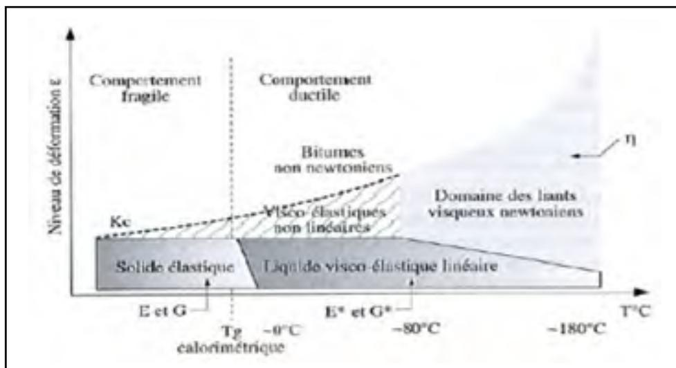
Figure 1.2 Classes de comportement du bitume en fonction de la déformation et de la température
