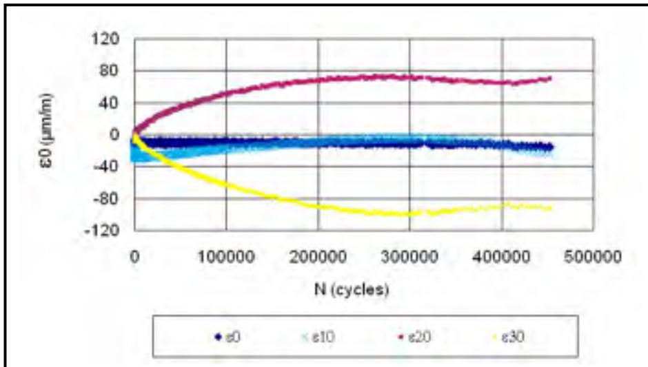
Figure 6.21 Évolution du centre de la déformation en fonction du nombre de cycles pour l'essai P3-B2 en mode de déformation (GB20 PG58-28;  $T_{\text{consigne}} = 10\text{ }^{\circ}\text{C}$ ;  $Fr = 10\text{ Hz}$ ;  $\epsilon_0 = 120\text{ }\mu\text{def}$ )
