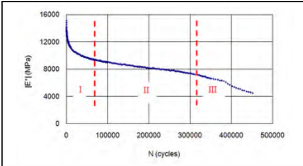
Figure 6.10 Évolution de la raideur en fonction du nombre de cycles pour l'éprouvette P3-B2, testée en mode de déformation (GB20 PG58-28;  $T_{\text{consigne}} = 10\text{ }^{\circ}\text{C}$ ;  $Fr = 10\text{ Hz}$ ;  $\epsilon_0 = 120\text{ }\mu\text{def}$ )
