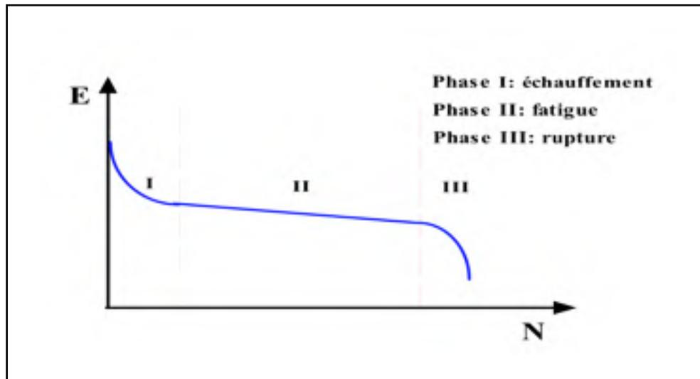
Figure 2.3 Distinction de trois phases différentes dans un essai de fatigue
