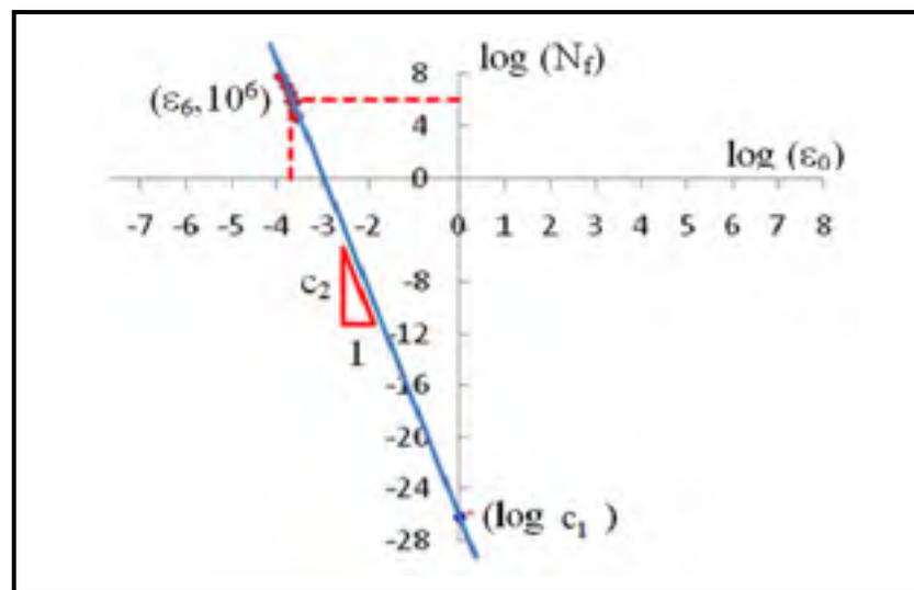
Figure 7.5 Courbe de Wöhler dans le domaine  $\log N_f$  vs  $\log \epsilon_0$  (m/m)
