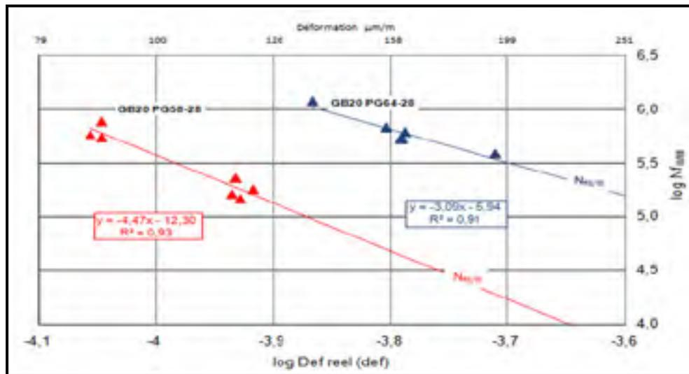
Figure 7.9 Durées de vie déterminées par le critère de transition de phase ( $N_{III}$ ) pour deux enrobés GB20 avec PG58-28 et PG64-28 à 10 °C et 10 Hz
