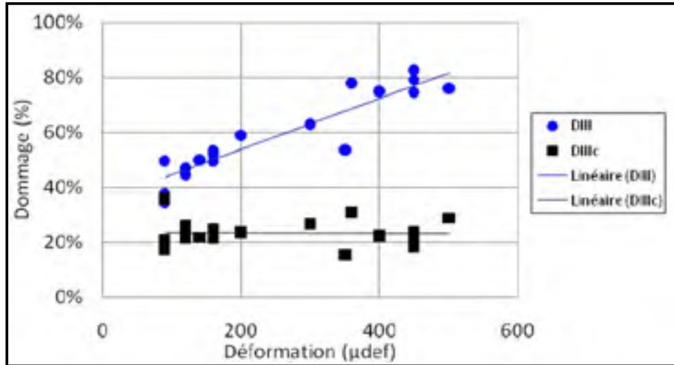
Figure 7.21 Valeurs du dommage à la transition entre la phase II et III pour les tests en fatigue de tension/compression à déformation imposée :  $D_{III}$  non corrigé et  $D_{IIIc}$  corrigé des effets biaisant.
