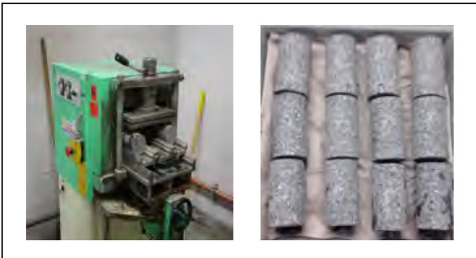
Figure 4.6 Resurfaceuse et éprouvettes obtenues
