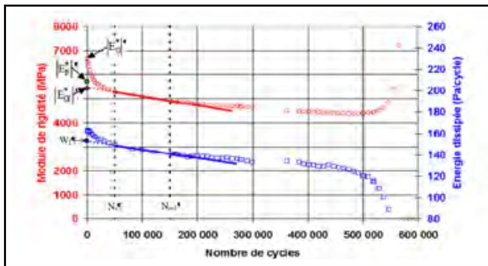
Figure 7.19 Évolution du module de rigidité et de l'énergie dissipée en fonction du nombre de cycles de sollicitation dans le cadre d'un essai de fatigue en contrôle de déplacement (10 °C; 10 Hz)
