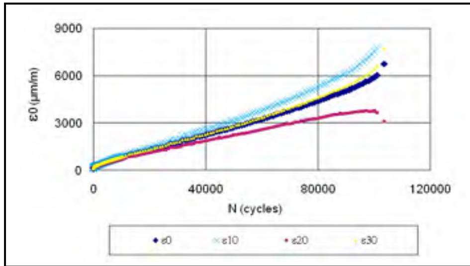
Figure 6.22 Évolution du centre de la déformation en fonction du nombre de cycles pour l'essai P2-D3 en mode de contrainte (GB20 PG64-28;  $T_{\text{consigne}} = 10 \text{ }^{\circ}\text{C}$ ;  $Fr = 10 \text{ Hz}$ ;  $\sigma_0 = 0,9 \text{ MPa}$ )
