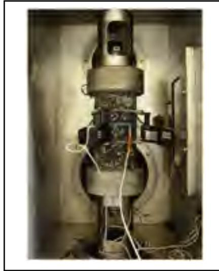
Figure 5.5 Montage de l'éprouvette dans l'enceinte thermique
