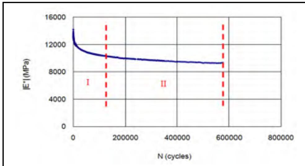
Figure 6.12 Évolution de la raideur en fonction du nombre de cycles pour l'essai P3-C4 en mode de déformation (GB20 PG58-28;  $T_{\text{consigne}} = 10 \text{ }^{\circ}\text{C}$ ;  $Fr = 10 \text{ Hz}$ ;  $\epsilon_0 = 90 \text{ }\mu\text{def}$ )
