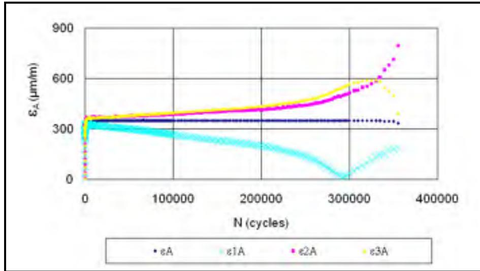
Figure 6.19 Illustration de l'effet d'accordéon observé lors de l'essai P2-C1 en contrôle de déformation (GB20 PG58-28;  $T_{\text{consigne}} = 30 \text{ }^{\circ}\text{C}$ ;  $Fr = 10 \text{ Hz}$ ;  $\epsilon_0 = 350 \text{ } \mu\text{def}$ )
