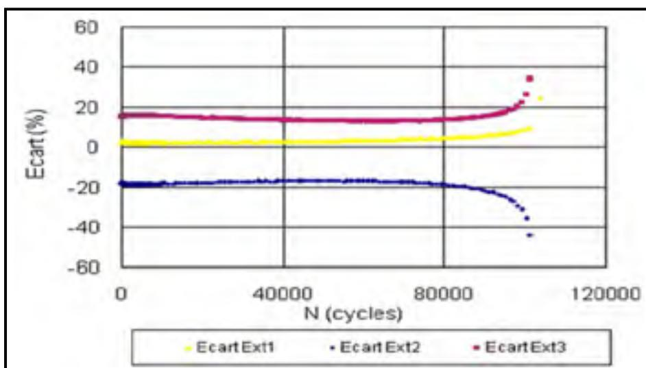
Figure 6.18 Écart moyen de la déformation en fonction du nombre de cycles pour l'essai P2-D3 en mode de contrainte (GB20 PG64-28;  $T_{\text{consigne}} = 10\text{ °C}$ ;  $Fr = 10\text{ Hz}$ ;  $\sigma_0 = 0,9\text{ MPa}$ )
