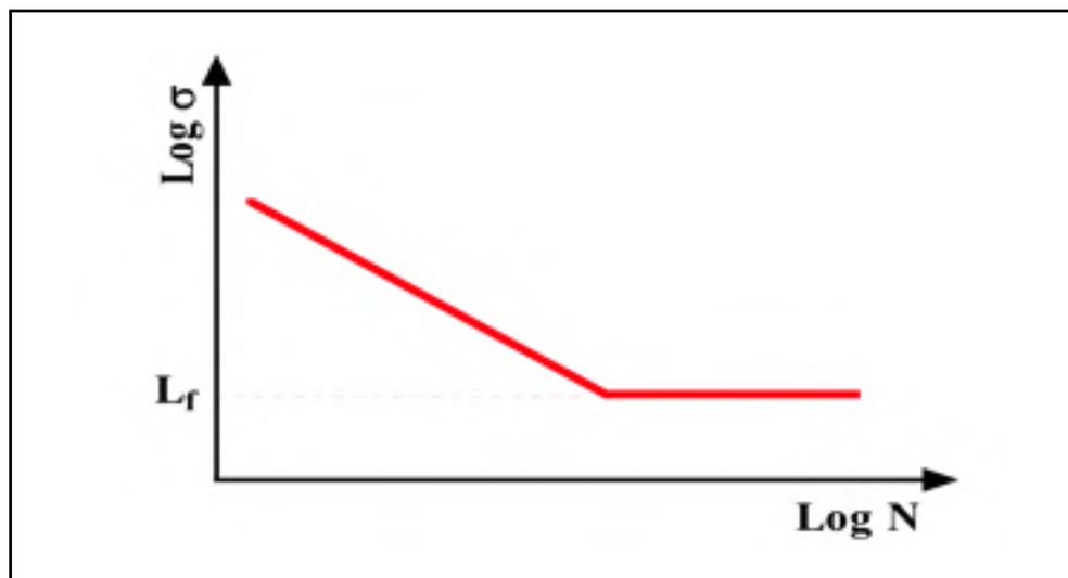
Figure 2.7 Limite d'endurance ou limite de fatigue
