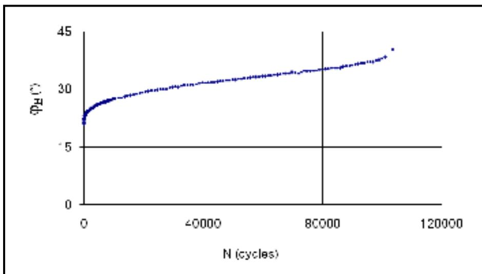
Figure 6.28 Évolution de l'angle de phase en fonction du nombre de cycles pour l'essai P2-D3 en mode de contrainte (GB20 PG64-28;  $T_{\text{consigne}} = 10$  °C;  $Fr = 10$  Hz;  $\sigma_0 = 0,9$  MPa)
