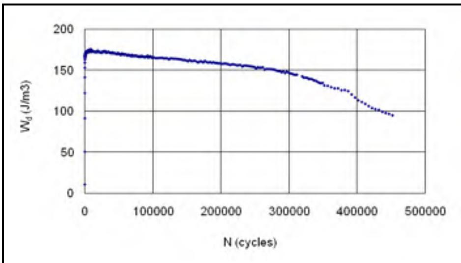
Figure 6.29 Évolution de l'énergie dissipée en fonction du nombre de cycles pour l'essai P3-B2 en mode de déformation (GB20 PG58-28;  $T_{\text{consigne}} = 10\text{ °C}$ ;  $Fr = 10\text{ Hz}$ ;  $\epsilon_0 = 120\text{ }\mu\text{def}$ )
