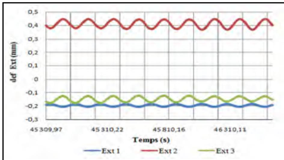
Figure 6.20 Déphasage entre les signaux de déformation observé lors de l'essai P2-C1 en contrôle de déformation (GB20 PG58-28;  $T_{\text{consigne}} = 30 \text{ }^{\circ}\text{C}$ ;  $Fr = 10 \text{ Hz}$ ;  $\epsilon_0 = 350 \text{ } \mu\text{def}$ )
