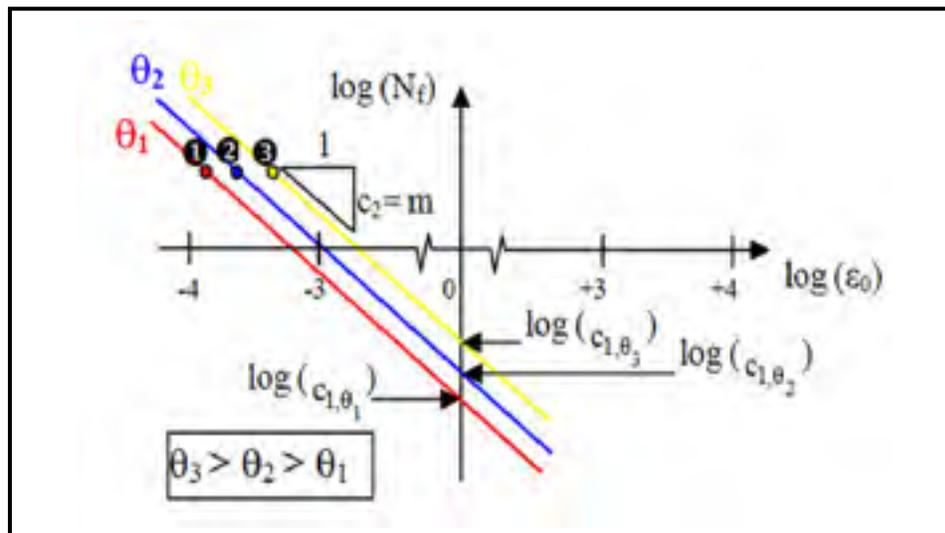
Figure 7.10 Schéma illustrant l'effet de la température ( $\theta_1$ ,  $\theta_2$  et  $\theta_3$ ) sur la durée de vie en fatigue mesurée en laboratoire en condition isotherme et suivie une fréquence de sollicitation donnée
