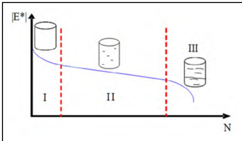
Figure 2.2 Illustration de l'évolution de la norme du module complexe  $|E^*|$  sous sollicitation cyclique suivant un essai en contrôle de déformation sur éprouvette cylindrique soumise à des efforts de traction/compression alternés autour de zéro
