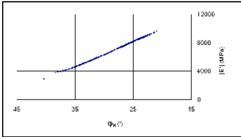
Figure 6.32 Présentation dans l'espace de Black pour l'essai P2-D3 en mode de contrainte (GB20 PG64-28;  $T_{\text{consigne}} = 10 \text{ }^{\circ}\text{C}$ ;  $Fr = 10 \text{ Hz}$ ;  $\sigma_0 = 0,9 \text{ MPa}$ )
