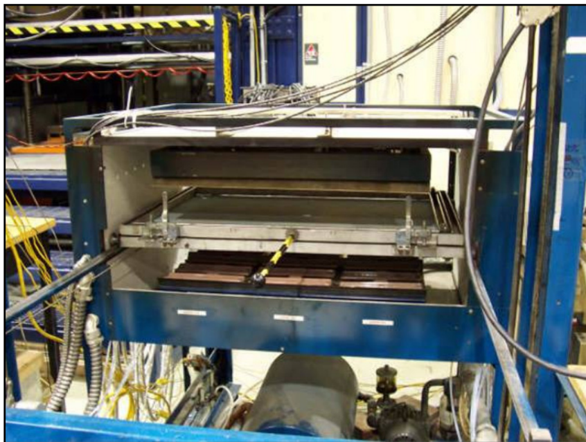
Figure 2.1 Four de thermoformage de AAA Thermoforming Machine Tirée de Beauchemin Turcotte (2010)
