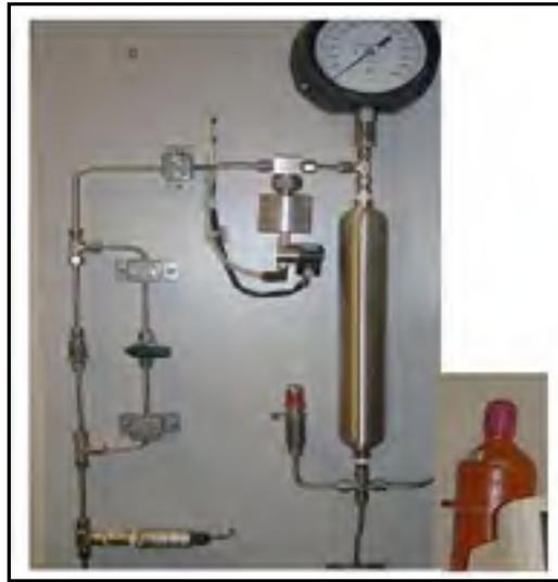
Figure 2.6 Système de pressurisation
