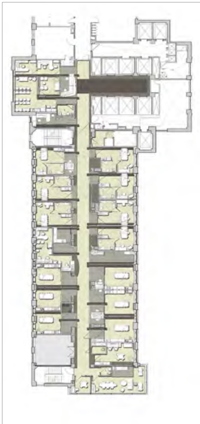
Figure-A III-2 Plan de réaménagement de l'unité des soins coronariens Reproduit avec l'autorisation du CUSM
