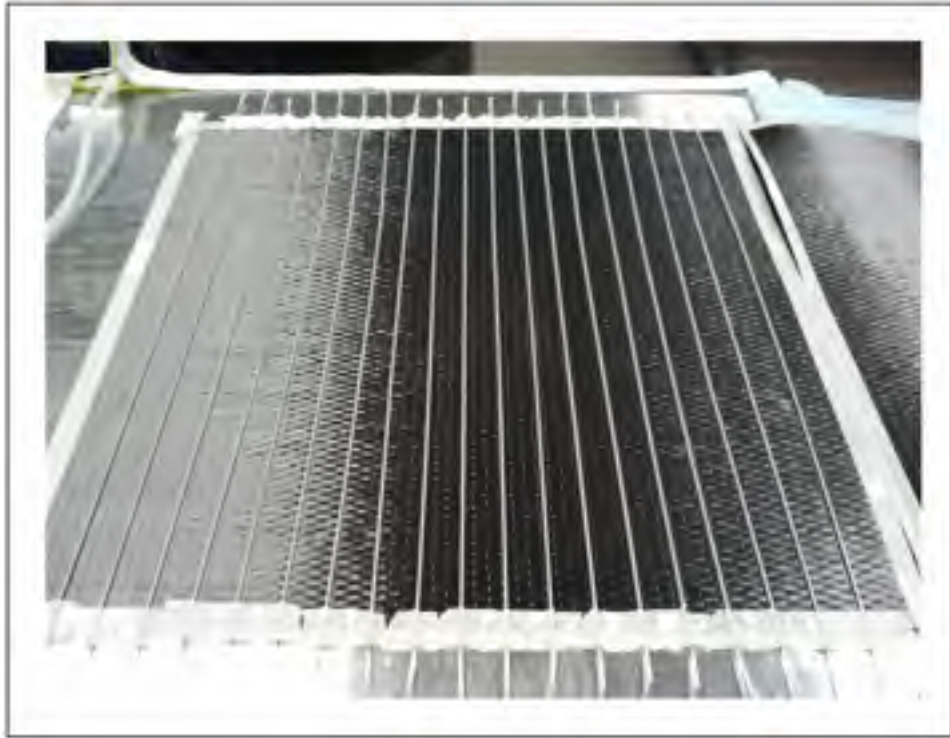
Figure-A I.2 Installation des fils sacrificiels
