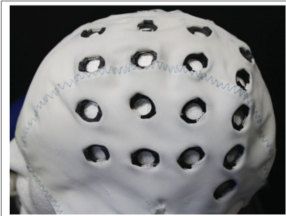
Figure 2.12 Casque utilisant la configuration EEG standard 10-10 avec le premier type de connecteur
