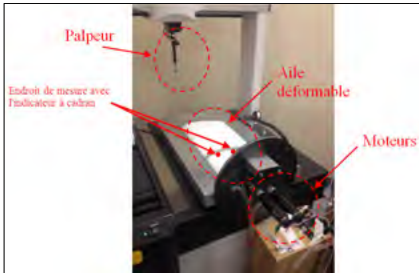
Figure 4.1 Photo de la maquette en composite dans la machine de mesures de coordonnées (Coordinate-Measuring Machine - CMM )
