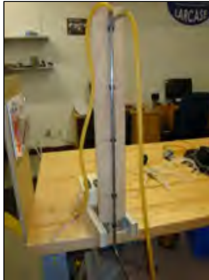
Figure 2.5 Système de guidage vertical de la sonde Pitot pour mesurer la vitesse de l'écoulement de l'air dans la soufflerie, lors de la calibration
