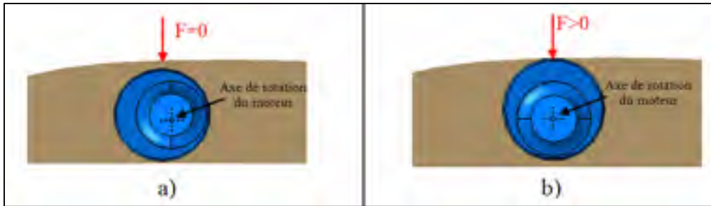
Figure 4.11 Représentation de la force F de la peau flexible sur l'axe excentrique. Cette force varie en fonction de la position de l'axe excentrique
