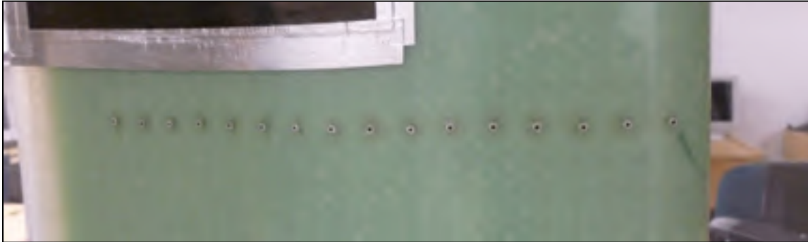
Figure 2.13 Visualisation des prises de pressions sur l'extrados du profil optimisé
