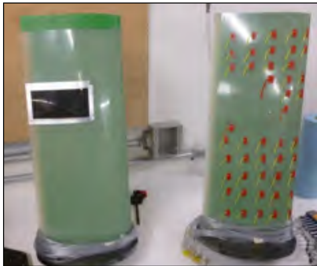
Figure 2.12 Photos des deux modèles d'aile en composite, à gauche l'optimisé (pour M=0.1 , \alpha = 0^\circ ) et à droite l'original
