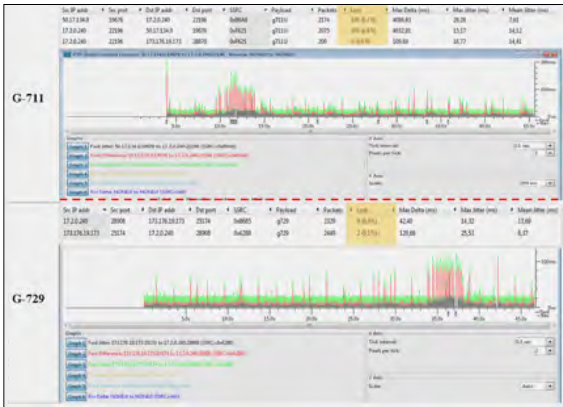
Figure 5.8 Test des performances des codecs G.711 et G.729 Tirée de Gadghadi, Allmendinger et Prost (2012)
