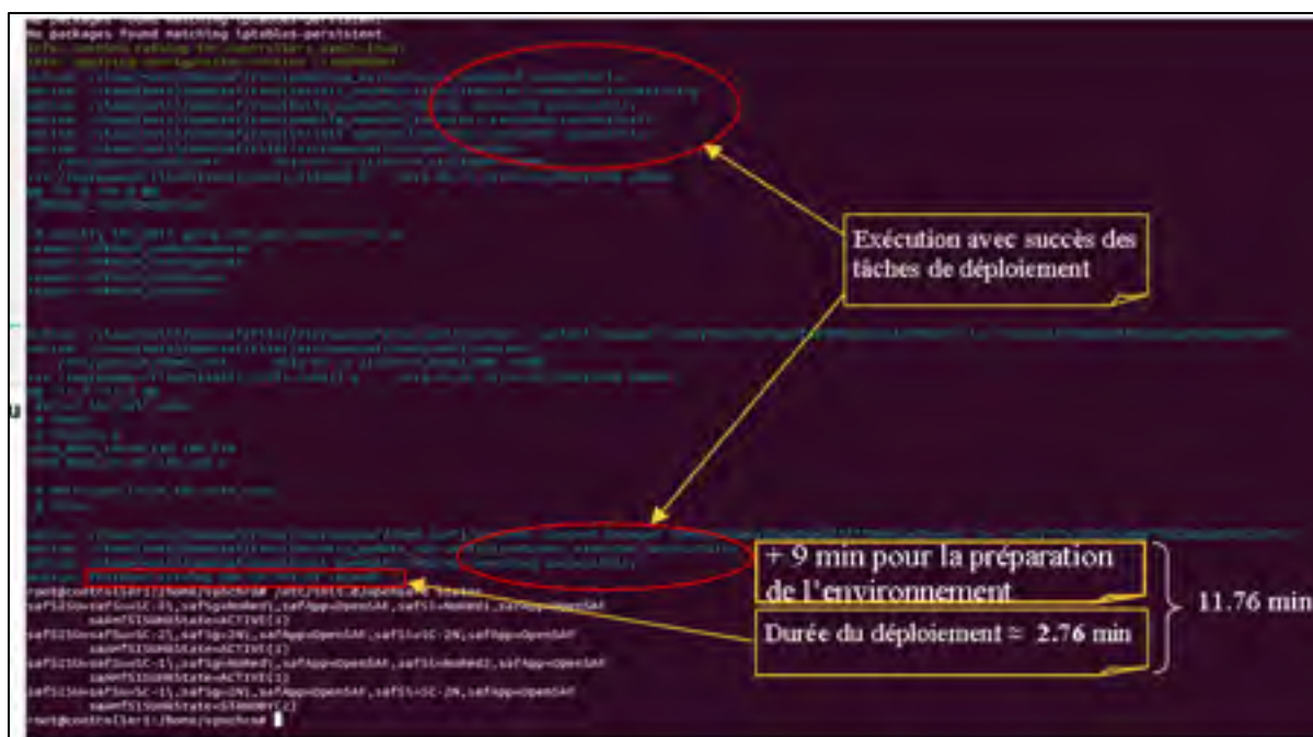
Figure 5.5 Déploiement réussi du contrôleur d'OpenSAF en moins de 166 secondes
