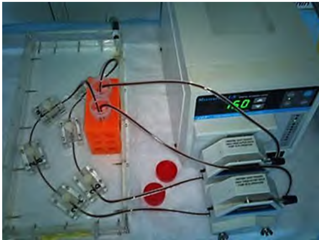
Figure 2.5 Système de perfusion constituant : la pompe péristaltique, les chambres et les tubulures de connexion.
