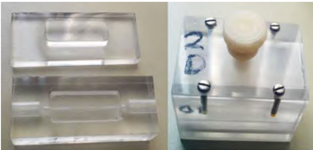
Figure 2.4 Chambre de perfusion contenant une fenêtre de diamètre intérieur de 2 mm et de 10 mm de longueur qui est fermée par un capuchon en plastique et resserré avec une vis.
