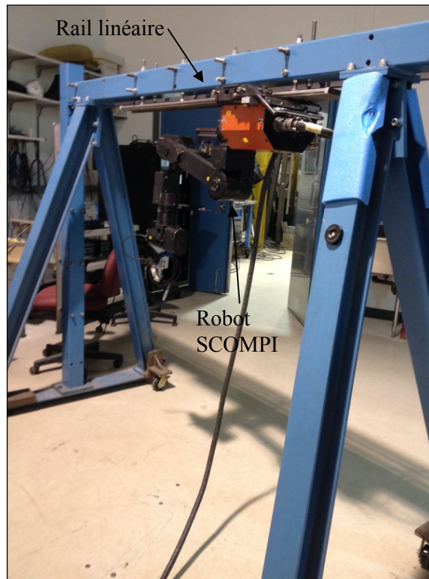
Figure 4.1 Robot SCOMPI installé sur un rail linéaire
