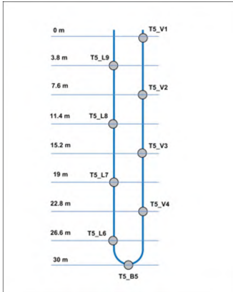
Figure 3.4 Positionnement des thermocouples dans le puits.
