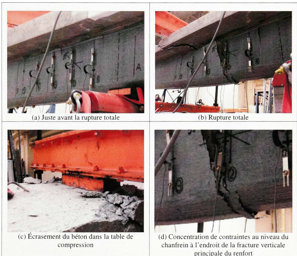
Figure 5.30 Modes de rupture – Spécimen S1-1L.
