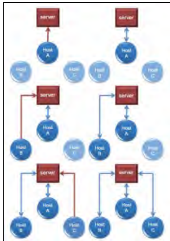
Figure 1.5 Architecture client-serveur Tirée de Steed et al. (2009)
