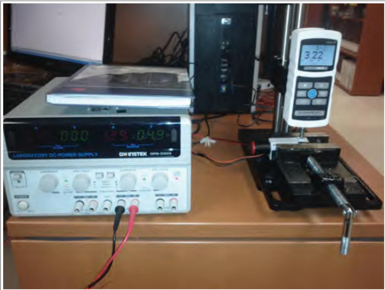
Figure 5.11 Montage pour effectuer le test de force
