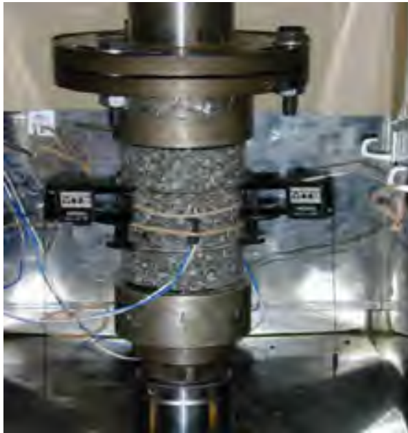
Figure 2.10 Illustration du montage d'une éprouvette sous la presse de sollicitation Tirée de Baaj (2002, p.50)
