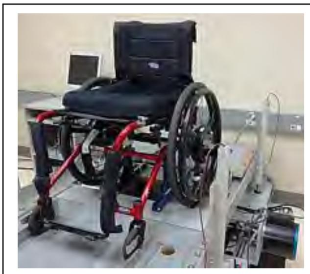
Figure 0.1 Simulateur de propulsion avec rétroaction haptique
