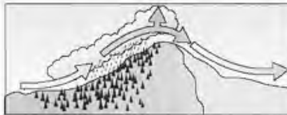
Figure 1.2 Illustration de la formation de nuage par montée forcée d'air. (Tirée de Klock et al. , 2001)
