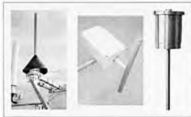
Figure 2.4 À gauche, le METEO, au milieu le Icemeter et à droite, le IceMonitor. (Tirées de Cattin et al. , 2007; Chum et Vojta, 2005; EGÚ Brno, 2006)
