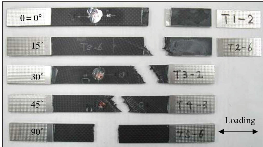
Figure 1-8 Rupture à TA en tension quasi-statique Figure tirée de Kawai et Taniguchi (2006)
