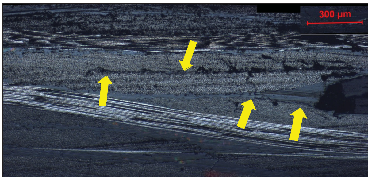
Figure 4-12 Fatigue T-T à TA et critère 15% agrandissement 50X, coupe 3B, (c)
