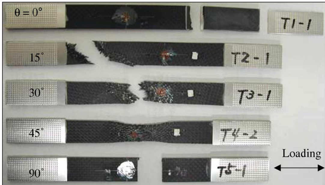
Figure 1-9 Rupture à 100°C en tension quasi-statique Figure tirée de Kawai et Taniguchi (2006)
