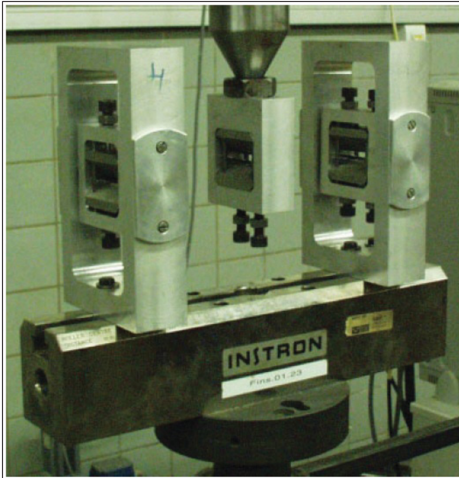
Figure 1-20 Montage de flexion Figure tirée de De Baere, Van Paepegem et Degrieck (2008)
