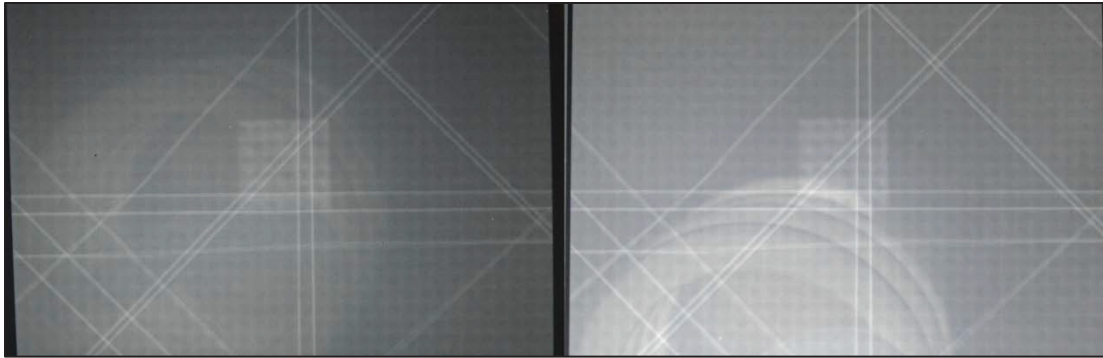
Figure 3-8 Inspection par rayon X - avant et après chargement en fatigue à 68% CUS en T-T à TA et critère de 10 %
