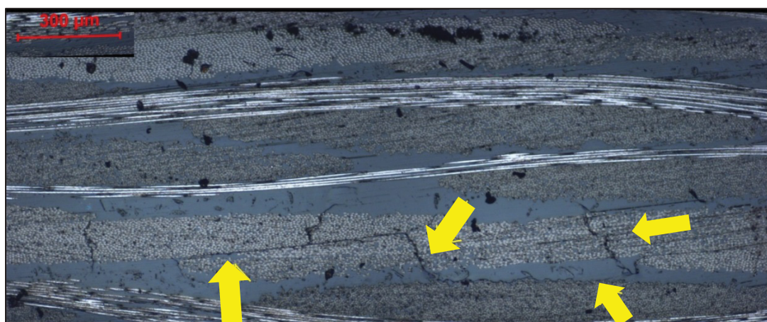
Figure 4-16 Fatigue T-T à TA et critère 15% agrandissement 50X, coupe 4B, (g)
