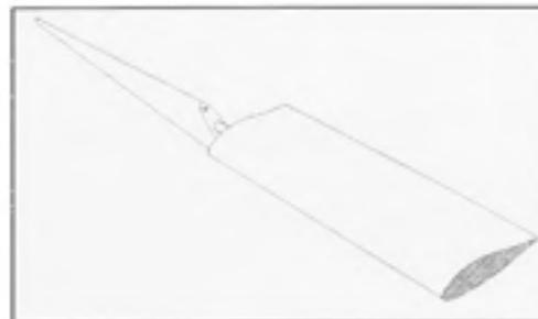
Figure I.2 Freins aérodynamiques de bout de pales, déployé.
