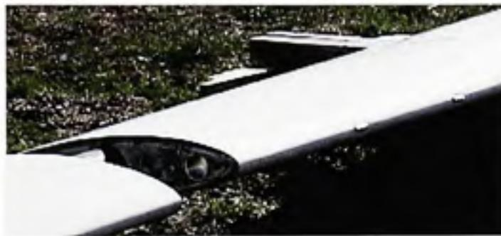
Figure I.3 *Provocateur de décrochage.*
