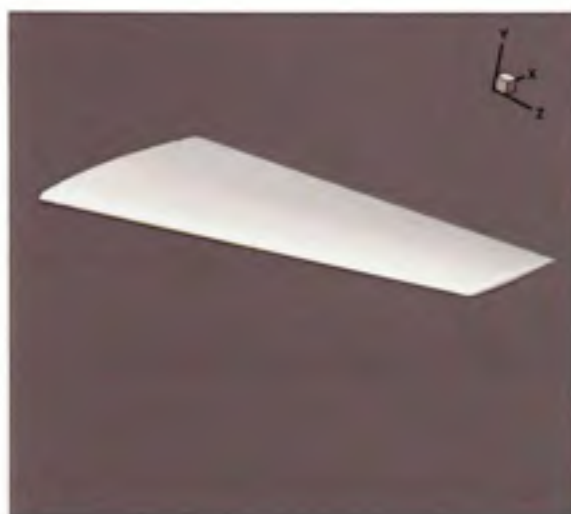
Figure 6.15 Modèle 3D de l'aile Onera M6.
