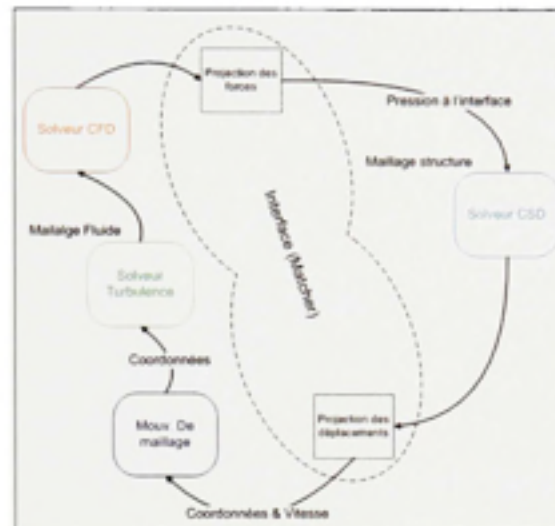
Figure 3.1 Approche séquentielle pour la résolution du problème d'aéroélasticité.
