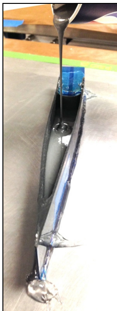
Figure 4.6 Coulée du coeur d'époxy L
