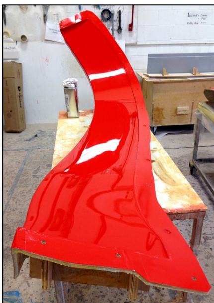
Figure 5.9 Pièce extrados du moule femelle après polissage
