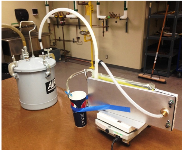
Figure-A X-11 Montage d'infusion complet
