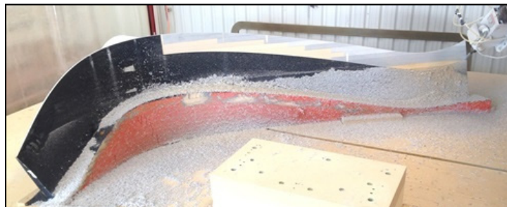
Figure-A VIII-8 Usinage de la portion mâle du moule
