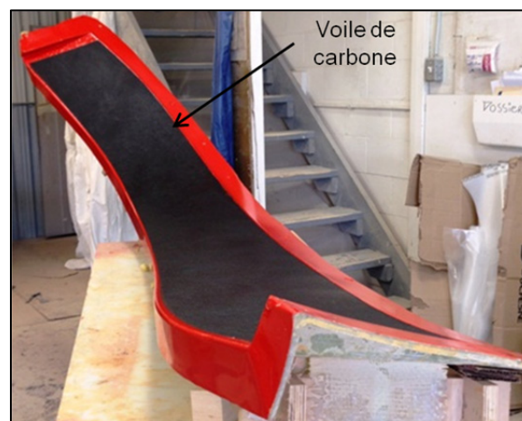
Figure 5.11 Peau de la coque après son laminage sur la pièce extrados du moule femelle
