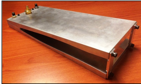
Figure 4.2 Moule des coques des préprototypes
