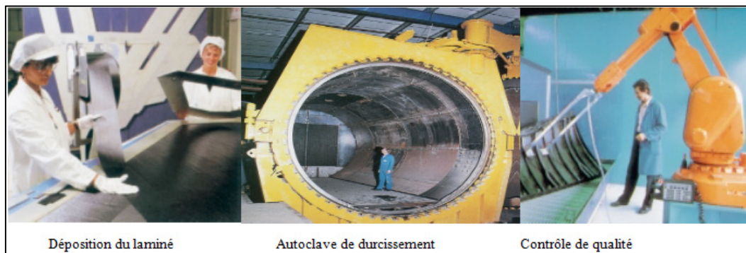
Figure 1.6 Procédé de fabrication traditionnel de matériaux composites de hautes performances Tiré de Marsh (2011)
