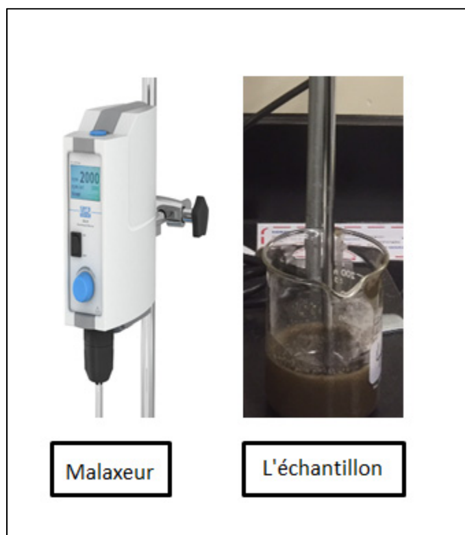
Figure 2.7 Un malaxeur (gauche), l'échantillon de bentonite, eau et sucre (droite)
