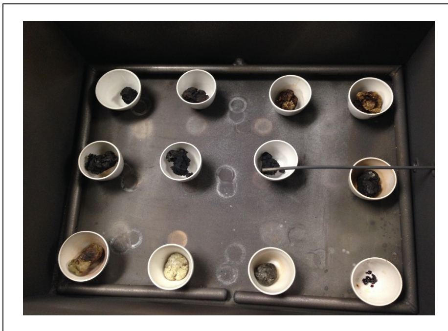
Figure 2.5 Les nanocomposites après avoir carbonisés dans le four inerte à 750 °C
