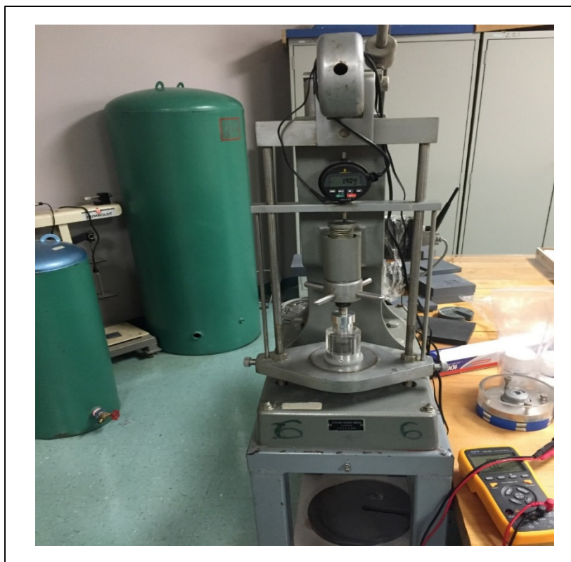
Figure 2.25 Appareil pour l'essai de consolidation utilisé pour mesurer la conductivité en fonction de la pression
