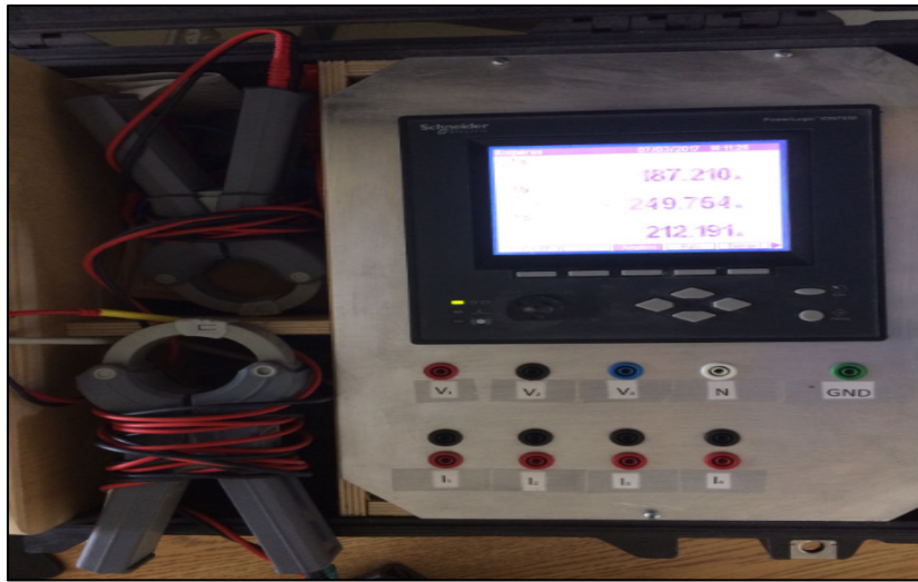
Figure 3.2 Analyseur PowerLogic ION 7650 de Schneider Electric utilisé pour les mesures en temps réel
