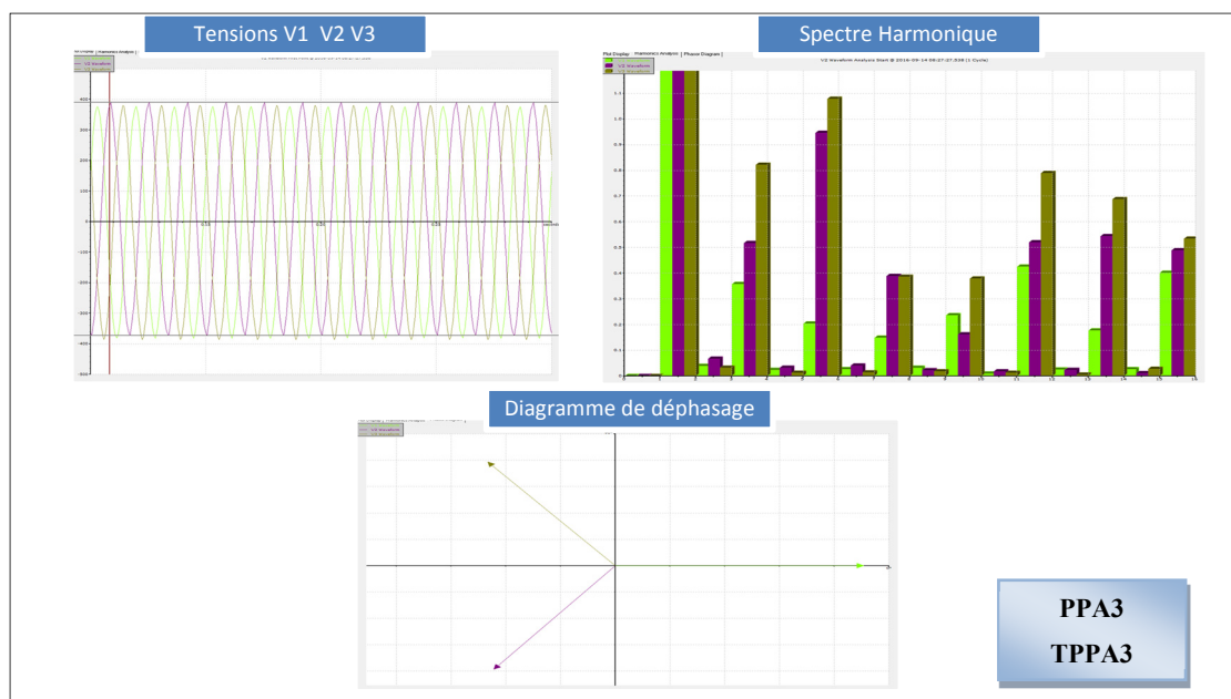
Figure 3.98 Formes d'ondes, spectre harmonique et déphasage des tensions V1 V2 V3 au niveau de la charge du panneau PPA3 connecté au transfo TPPA3
