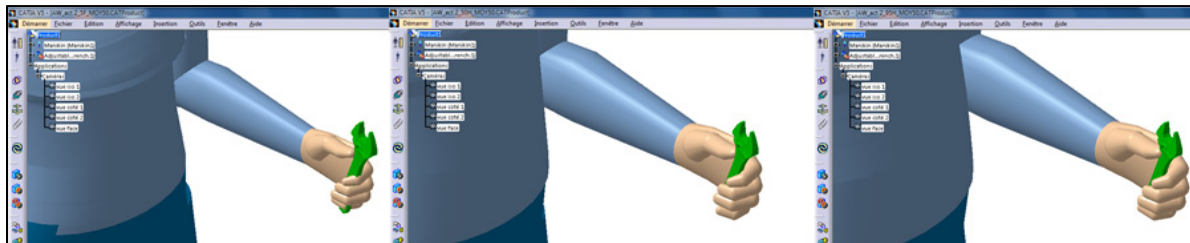
Figure_I 13 : Préhension « visser tirer », clé à molette, F5, H50 et H95
