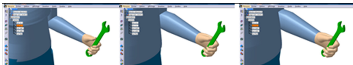
Figure_I 10 : Préhension « visser tirer coté ouvert », clé plate, F5, H50 et H95
