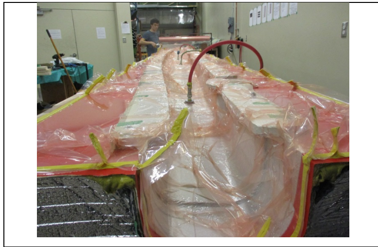
Figure 5.6 Mise sous vide du stratifié de coque
