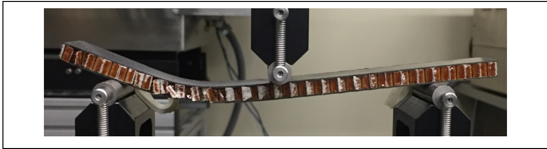
Figure 3.17 Rupture au cisaillement transverse puis rupture du joint collé au pelage
