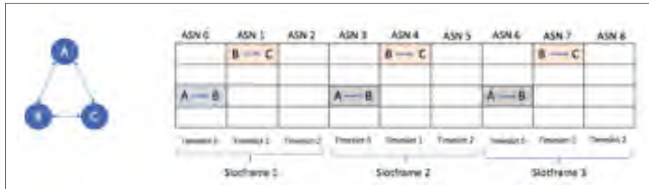
Figure 1.2 Structure d'une slotframe TSCH.
