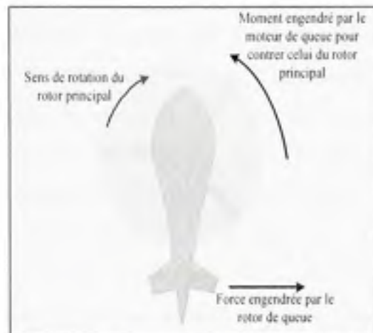
Figure 1-4 Rôle du rotor de queue. (Coyle Shawn, 1996)
