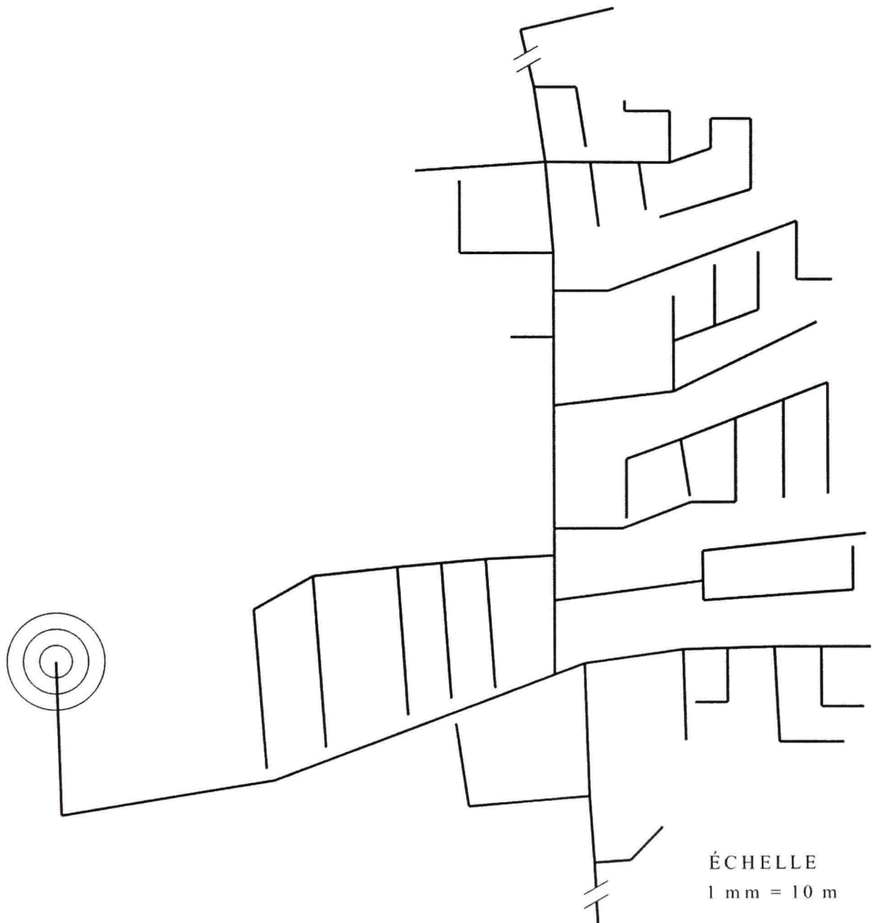
Figure 2.3 Parcours du réseau de chauffage de district.
