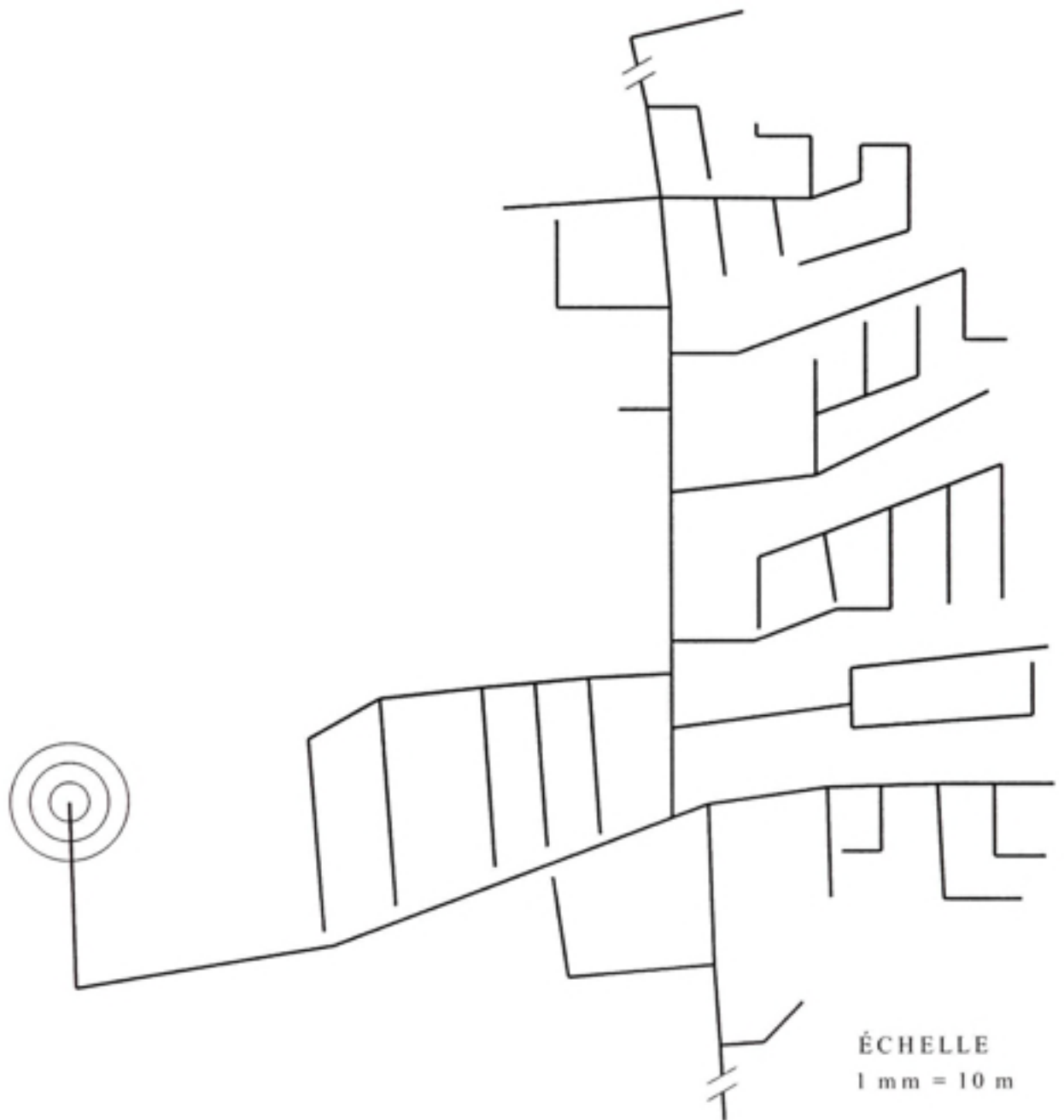
Figure 2.3 Parcours du réseau de chauffage de district.
