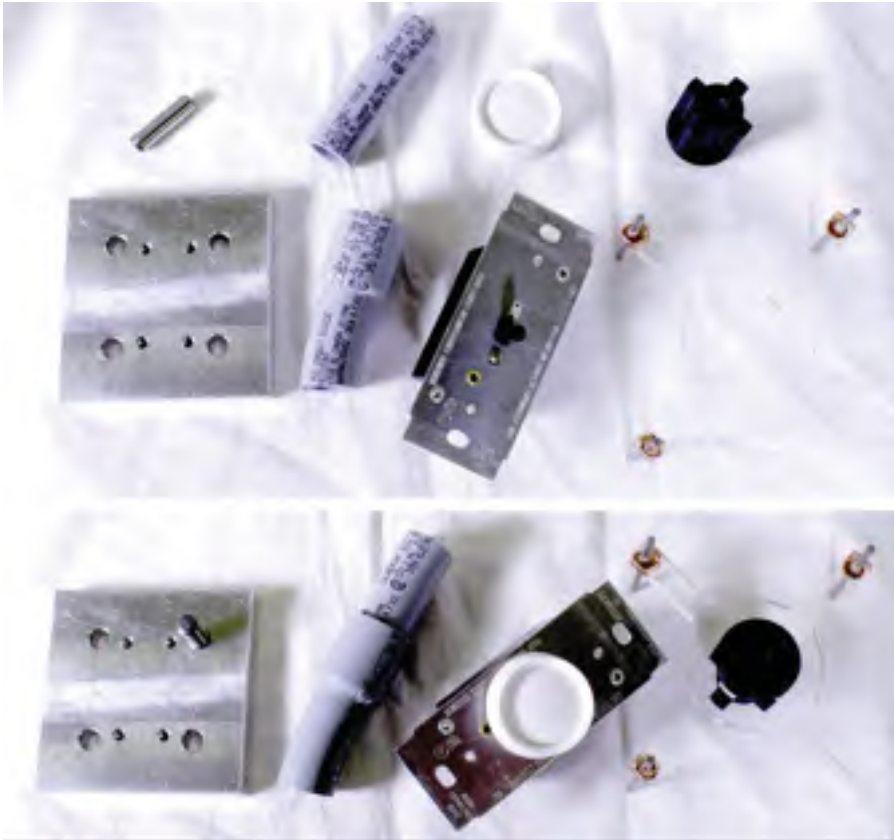
Figure 3.5 Les objets utilisés dans les bases de données de test. De gauche à droite : goujon métallique, tube de PVC, variateur de lumière et l'insertion en X.
