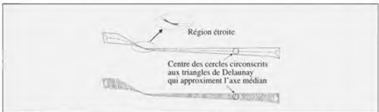
Figure 1.23 Utilisation de la MAT comme critère d'identification des zones étroites sur les faces planes (Lee et al. , 2003b).
