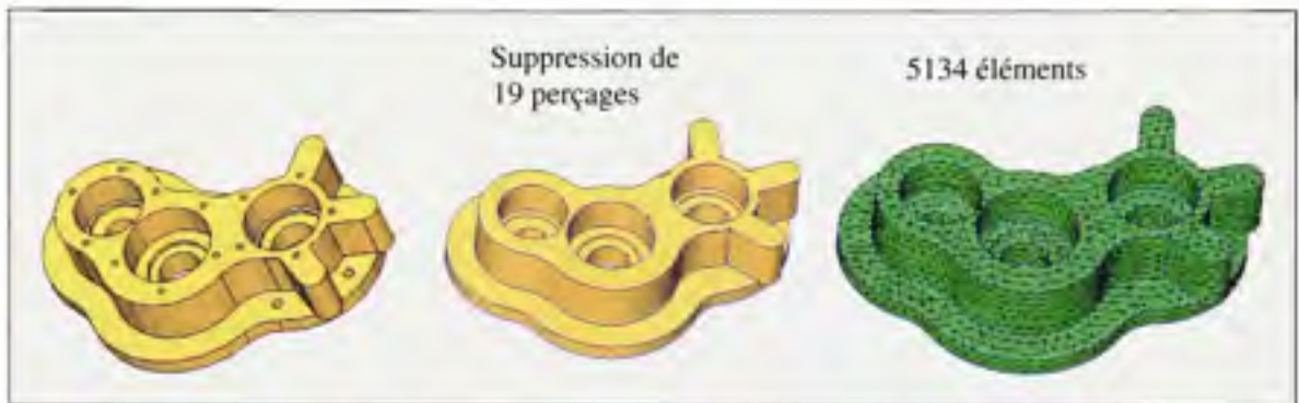
Figure 6.2 Modèle CAO d'un carter de pompe : adaptation automatique des détails de forme et topologiques TCM, et maillage trans-carreaux.
