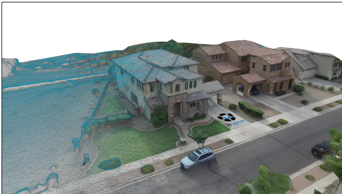
Figure 1.17 Exemple de reconstitution par photogrammétrie Tirée de (Valente, 2017)
