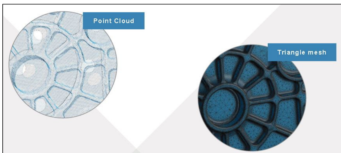
Figure 2.16 Illustrations d'un nuage de points et d'un maillage triangulaire Tirée de (Creaform®, 2014)
