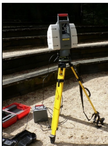
Figure 1.10 Exemple de tourelle Lidar Tirée de (Monniaux, 2007)
