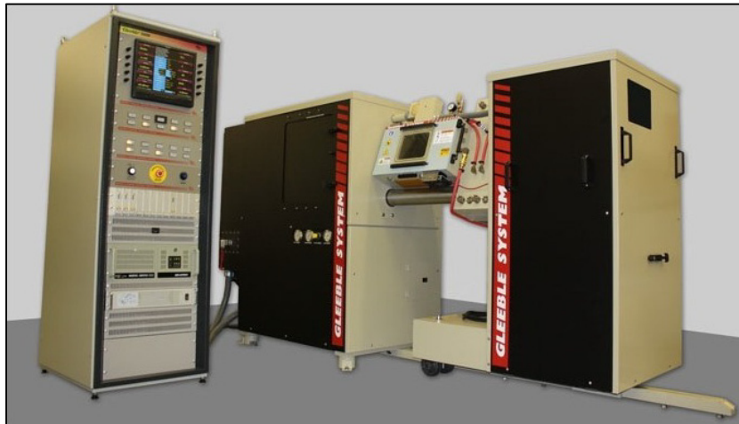
Figure 2.2 Simulateur de compression à chaud Gleeble-3800 (DSI, 2010)
