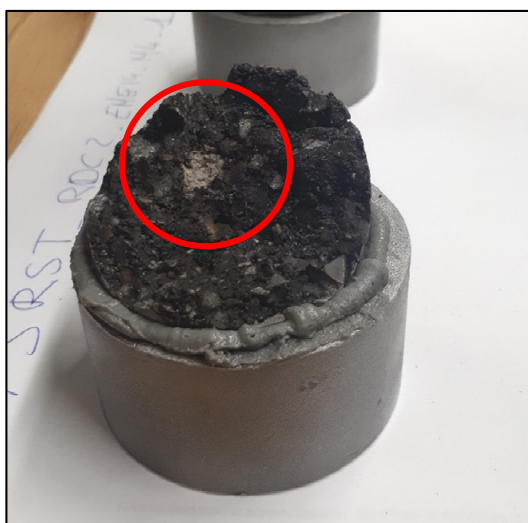
Figure 4.3 Exemple de fines mal malaxées dans le corps d'épreuve
