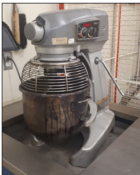
Figure 3.4 Malaxeur Hobart© utilisé pour les essais de dmm et de PCG
