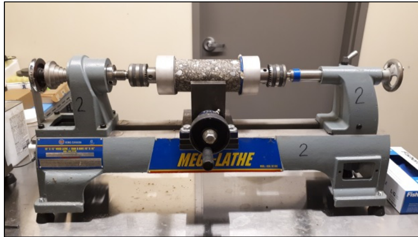
Figure 3.6 Bancs de collage utilisé pour coller le premier casque
