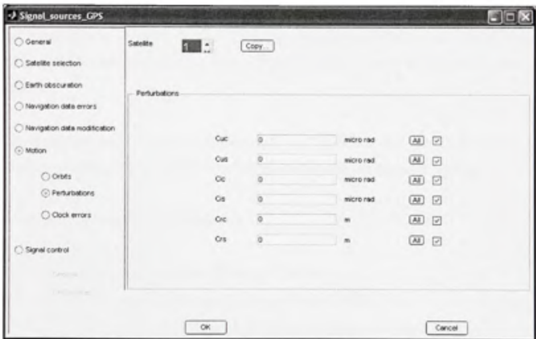
Figure 2.2 Configuration des paramètres de correction d'orbites.
