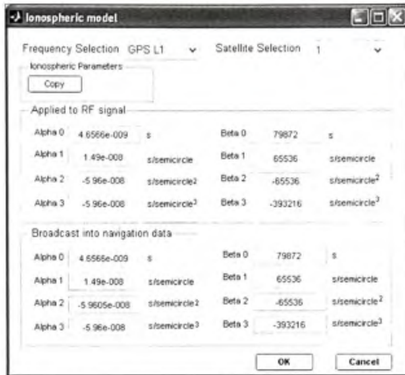
Figure 2.5 Configuration des paramètres ionosphériques.
