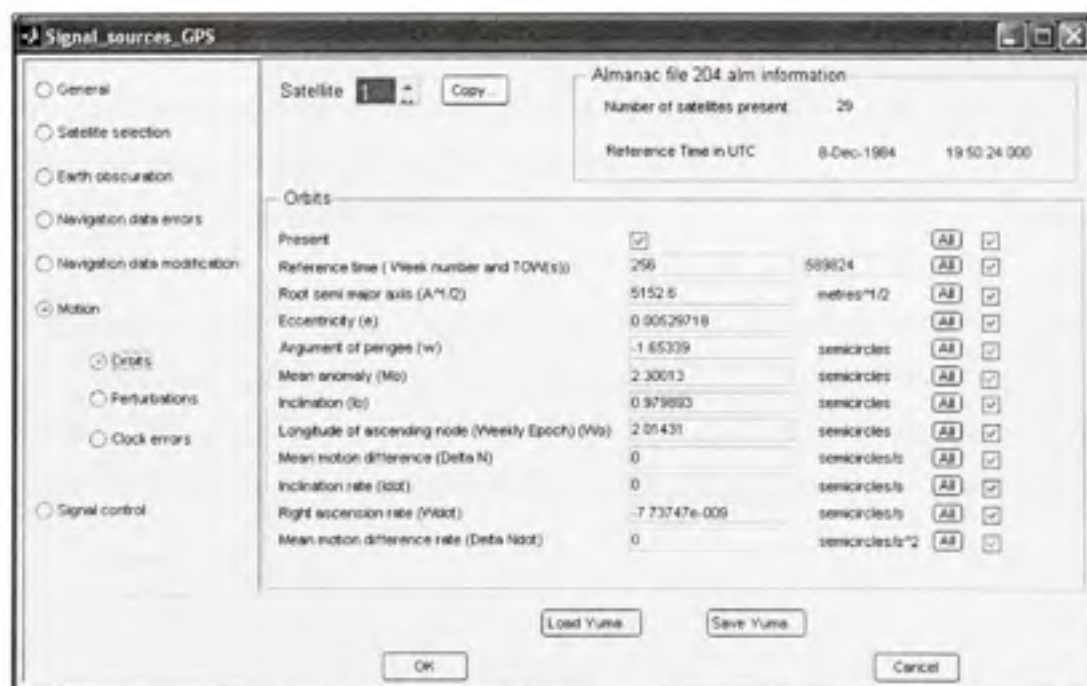
Figure 2.1 Configuration des paramètres orbitaux.
