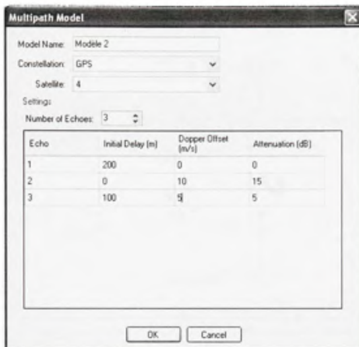
Figure 4.6 Interface graphique du générateur de modèles de multi-trajets.
