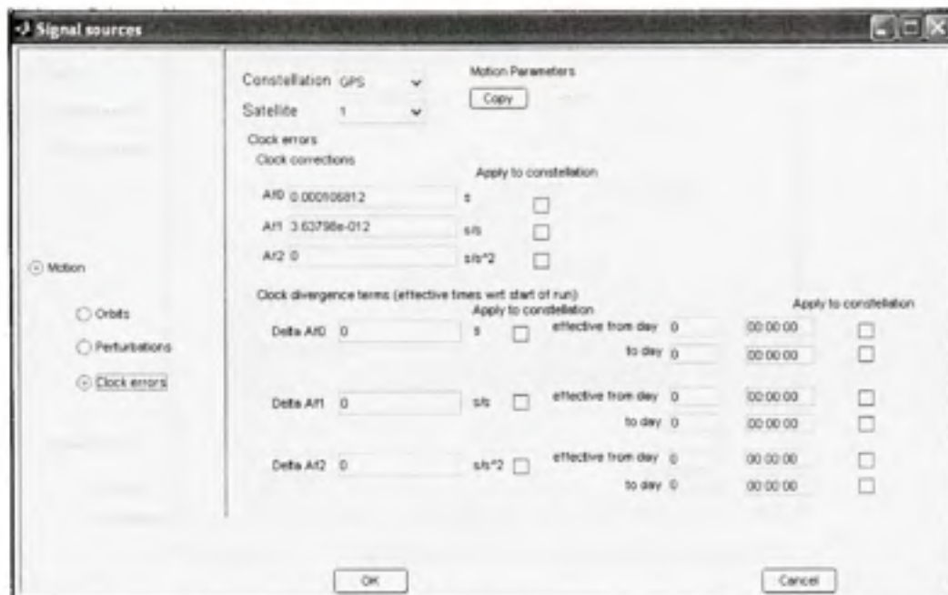
Figure 2.3 Paramètres de correction des horloges des satellites.
